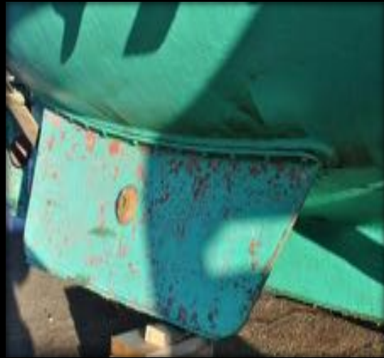
keels on a CW 28'-6" & thick keel shoe
