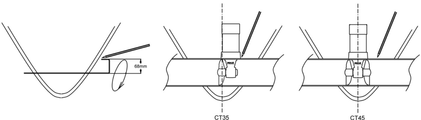
Replacer le tunnel. Stratifier (résine renforcée fibres de verre) en appliquant le mélange à l'intérieur et à l'extérieur sur toutes les zones, et en faisant bien attention de remplir tous les espaces entre la coque et le tunnel. Stratifier avec un minimum de 8 couches de tissus et de **RESINE ISOPHTALIQUE** alternées avec du mat et roving.
