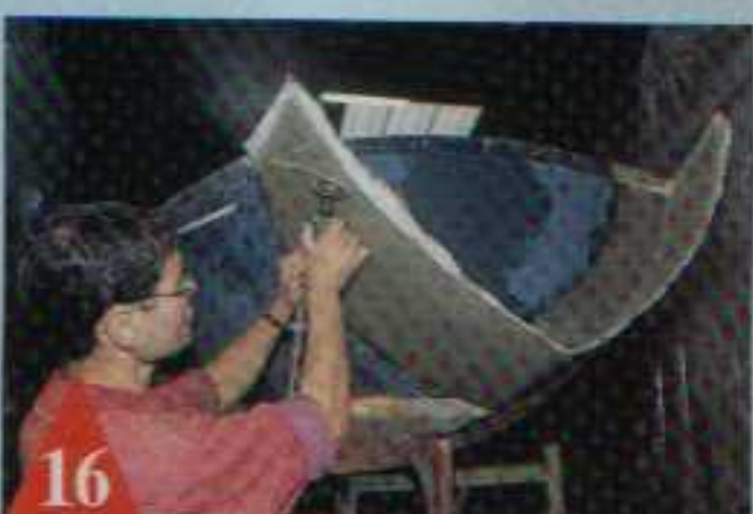
Le découpage du polyester (environ 4 mm d'épaisseur) s'effectue à la détoureuse.
