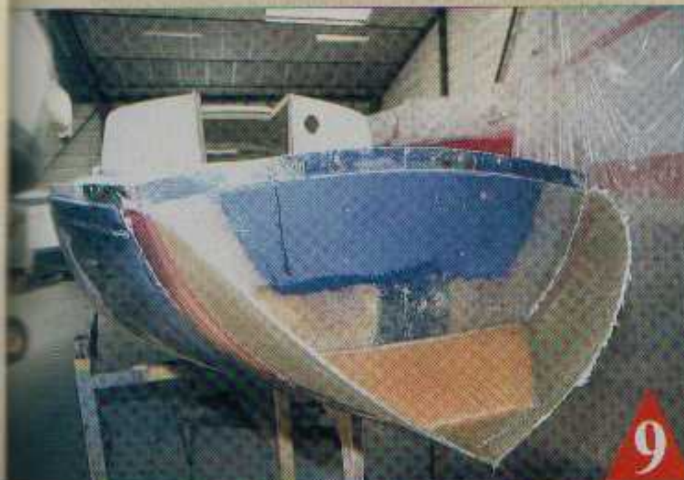
Vous noterez que le plancher s'arrête à trois centimètres de l'extrémité de la jupe afin de préserver la reprise de strat'.
