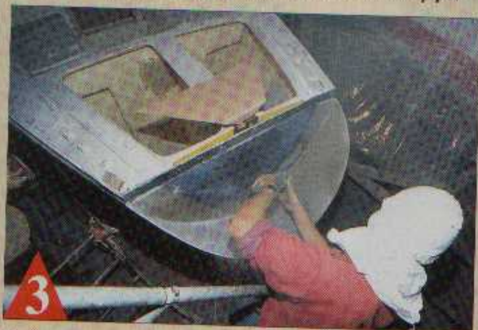
3 Un ponçage (encore et toujours !) du tableau et des reprises de strat' de la jupe est indispensable pour l'accrochage.
