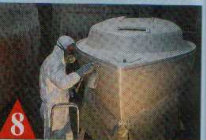
8 Même si le rendu de l'apprêt est satisfaisant, il est impératif de le poncer après séchage.
