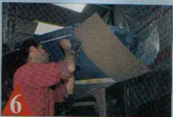
6 Sur le Sylphe, la difficulté vient de l'arête centrale qui impose deux plaques qui...
