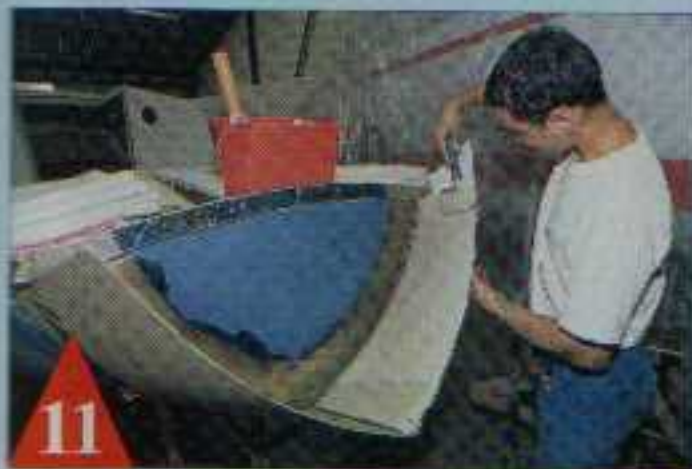
Les tissus sont posés alternativement (mat, roving, mat...) et débullés à chaque couche.
