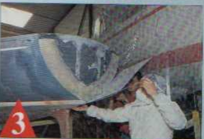
3 À la fois résistant, souple et lisse, le formica est parfait pour faire office de moule.
