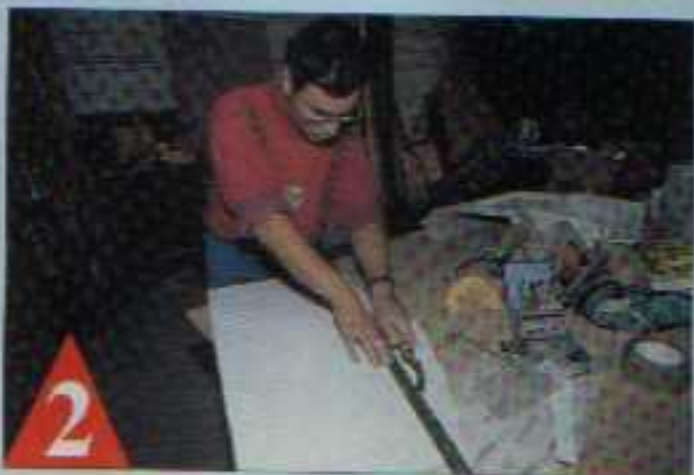
2 Après des ébauches de formes en carton, on coupe deux plaques de formica.
