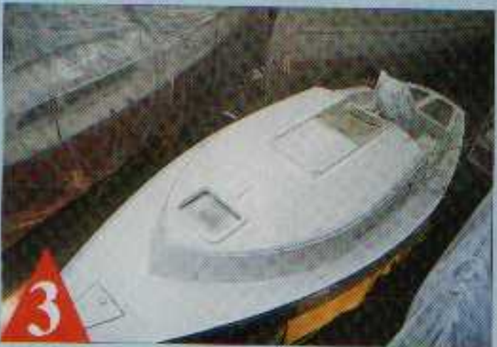
3 Un apprêt PU qui facilite la reprise des petits défauts et qui se ponce quatre heures après...
