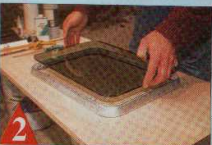
2 ... le panneau d'altuglas, en prenant soin que le joint « dégueule » bien de partout.
