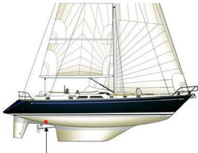
Transducteur près de l'hélice à l'arrière
