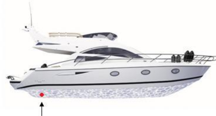
Transducteur près de l'hélice à l'arrière
