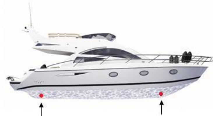
Transducteur près de l'hélice à l'arrière et un à l'avant juste derrière le propulseur d'étrave
