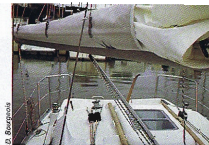
Sans barre d'écoute et avec le palan qui se frappe sur le liston, la grand-voile n'embarasse plus le cockpit au port.
