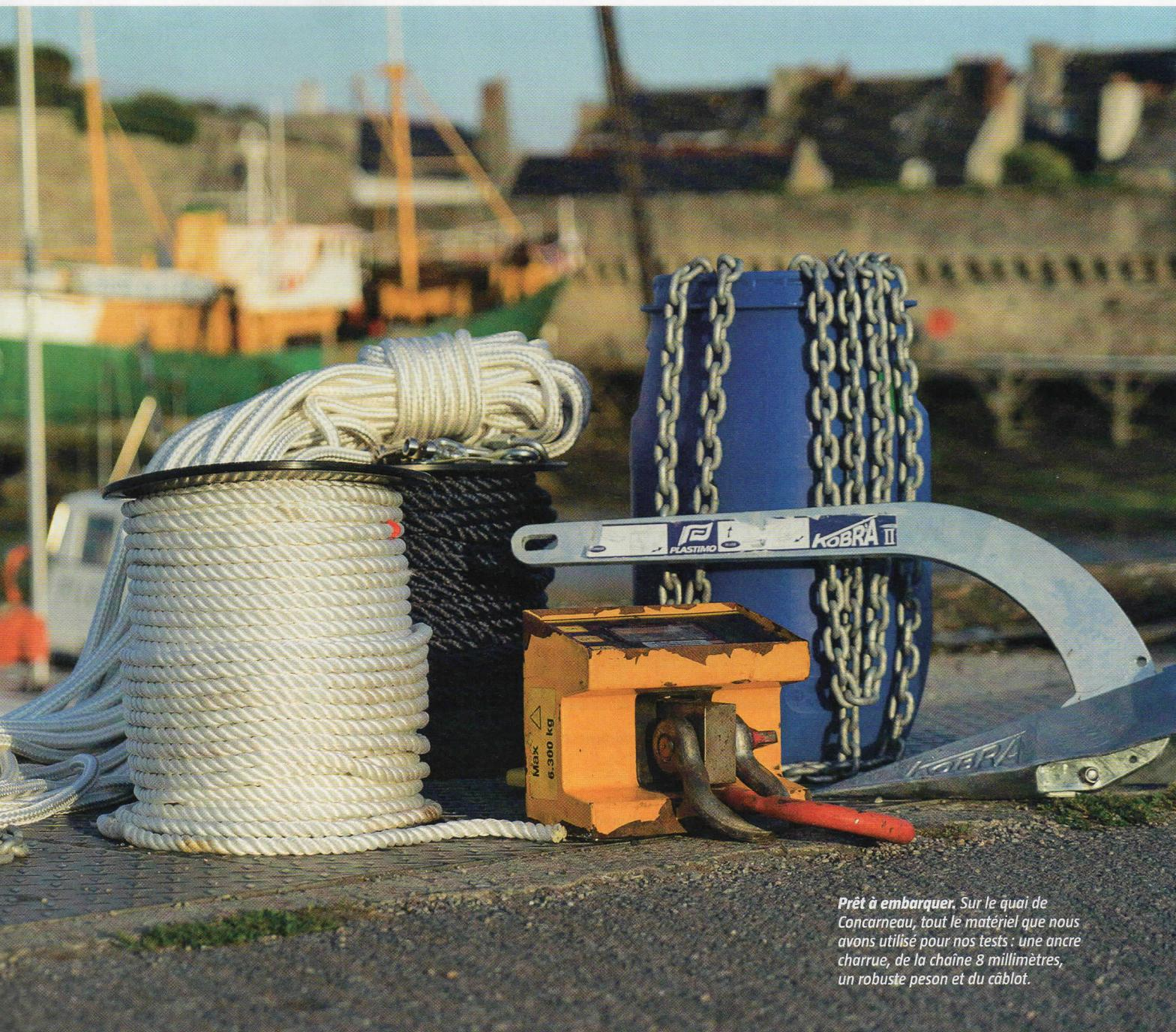
*Prêt à embarquer. Sur le quai de Concarneau, tout le matériel que nous avons utilisé pour nos tests : une ancre charrue, de la chaîne 8 millimètres, un robuste peson et du câblot.*
