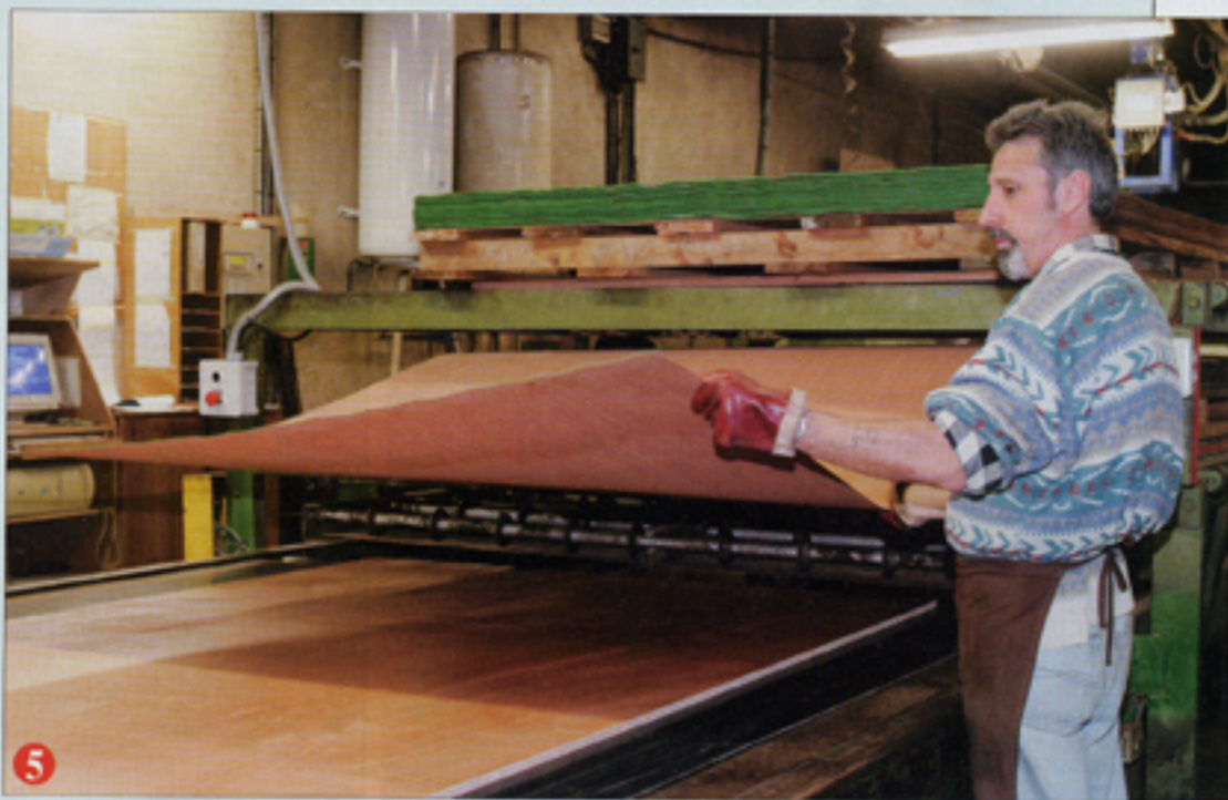
Le collage du placage. A la demande, le placage, qu'il soit constitué de moabi, de douka, de merisier... passe dans des rouleaux où il reçoit de la colle avant d'être posé sur le panneau de contreplaqué. Puis l'ensemble passe dans de grandes presses.
