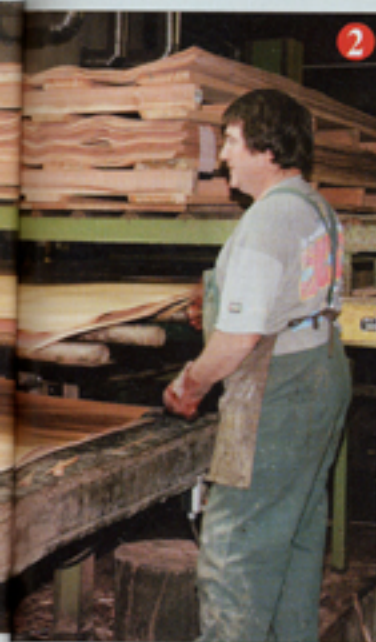
2 L'assemblage des panneaux. Une fois séchées, les plaques d'okoumé découpées à la taille des panneaux standards (2,50 ou 3,10 m de long) sont encollées puis empilées à 90 degrés afin de croiser les plis qui composeront le produit final.
