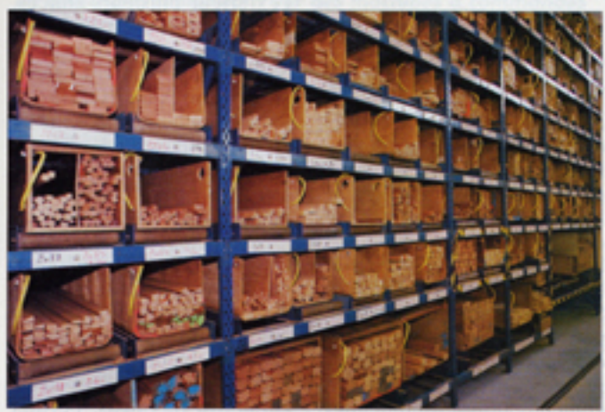
A partir de massifs, la menuiserie Bénéteau prépare plus d'une vingtaine de profilés utilisés pour les aménagements.
