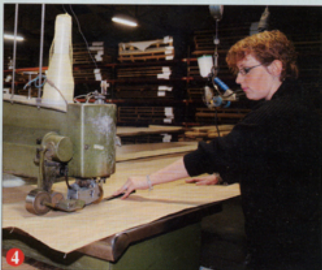
4 L'assemblage du placage. D'une faible largeur, les bandes de placage sont encollées sur chant dans cette machine afin de constituer au final des pièces de grandes dimensions.
