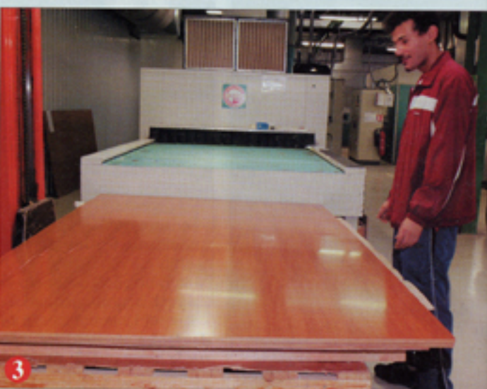
3 Dernière phase. Chaque panneau recouvert de son placage subit plusieurs passages de couches de vernis avant d'être séché. Là, au sortir de cette machine, il est prêt à être usiné.
