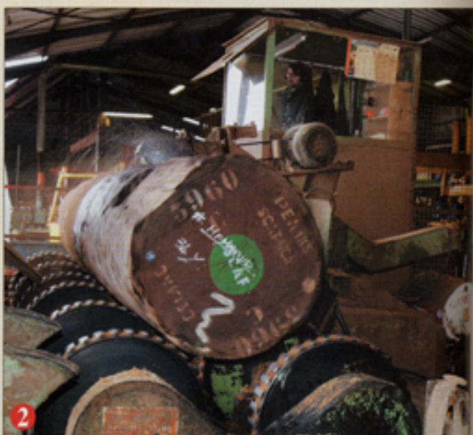
2 Le décorçage. Quelle que soit l'essence, la grume se voit débarrassée de son écorce, opération durant laquelle elle est animée d'un mouvement circulaire et longitudinal.
