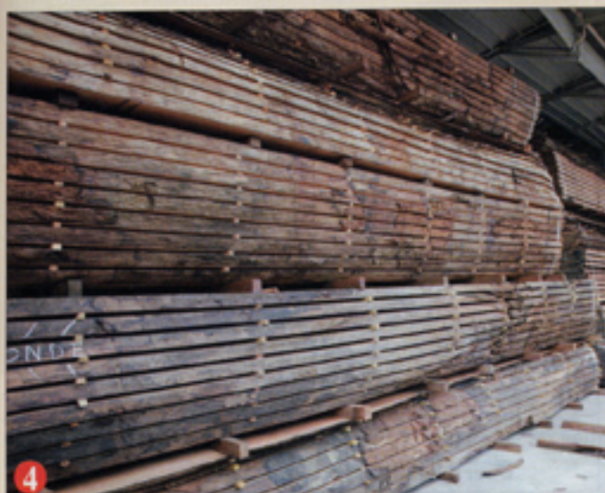
Le séchage mécanique. Les plots sont entreposés entre 4 et 6 semaines dans des enceintes fermées de 80 à 100 m 3 . La température monte par étapes, de 20 jusqu'à 80 degrés.
