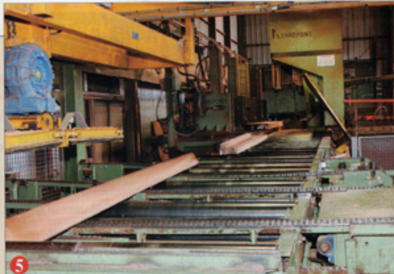
Le délignage. Les plots une fois séchés sont sciés en différentes dimensions sur des machines à commandes numériques.
