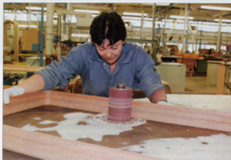
Chez Bénéteau, le ponçage des entourages de portes en bois moulé réclame une bonne dose de savoir-faire.
