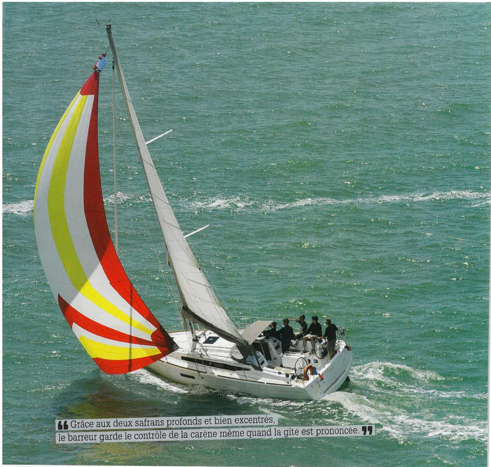
« Grâce aux deux safrans profonds et bien excentrés, le barreur garde le contrôle de la carène même quand la gîte est prononcée. »
