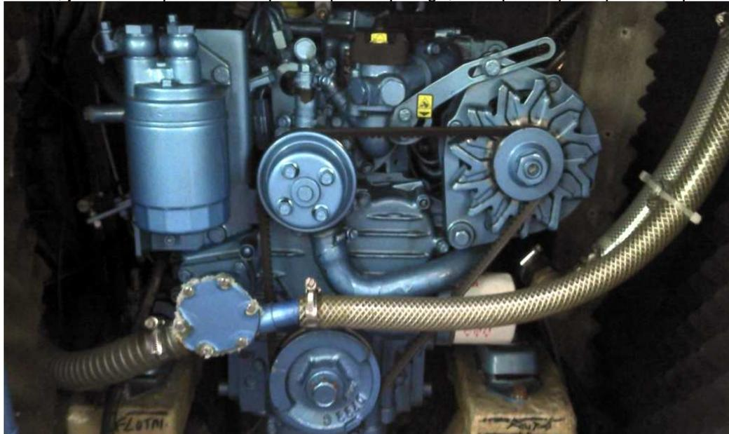
le meccano de nanni m'avait dit que c'était vachement important de ne pas avoir de point de corrosion sur les bords des joints car la boite est en alu (d'ailleurs il y en a un sur ton moteur )
