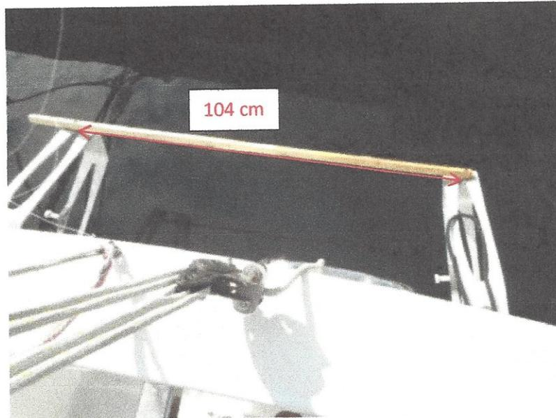
*Mesure faite avec un réglelet en bois, percé à 104 cm.*
