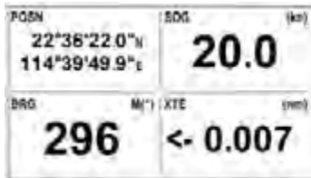
Exemple d'affichage numérique (quatre cellules)
