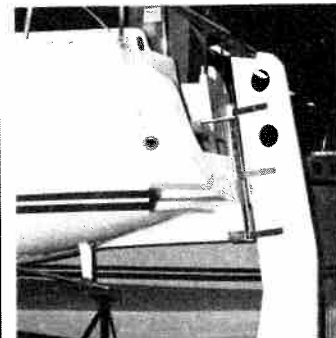
Après essais, le safran a été compensé et ses ferrures renforcées.
