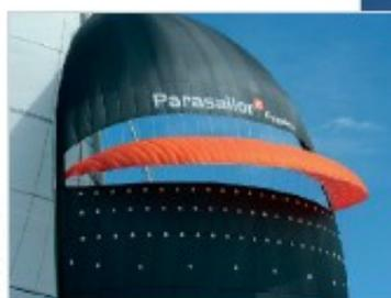
Pour affaler, il suffit de tirer sur le va-et-vient de la chaussette. Le passage de l'aile dans la bouche ralentit à peine l'opération.
