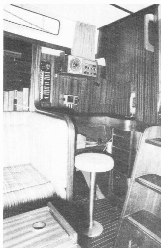
A la table à cartes, montée dans le sens longitudinal, est associé un tabouret fixé au sol. On notera la courbure de la fargue
