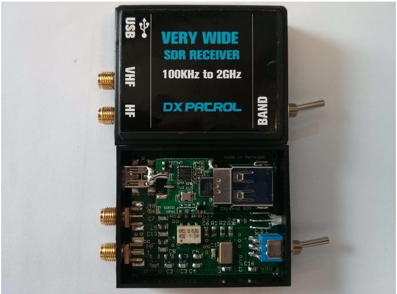
L'interrupteur sélectionne l'entrée antenne utilisée
