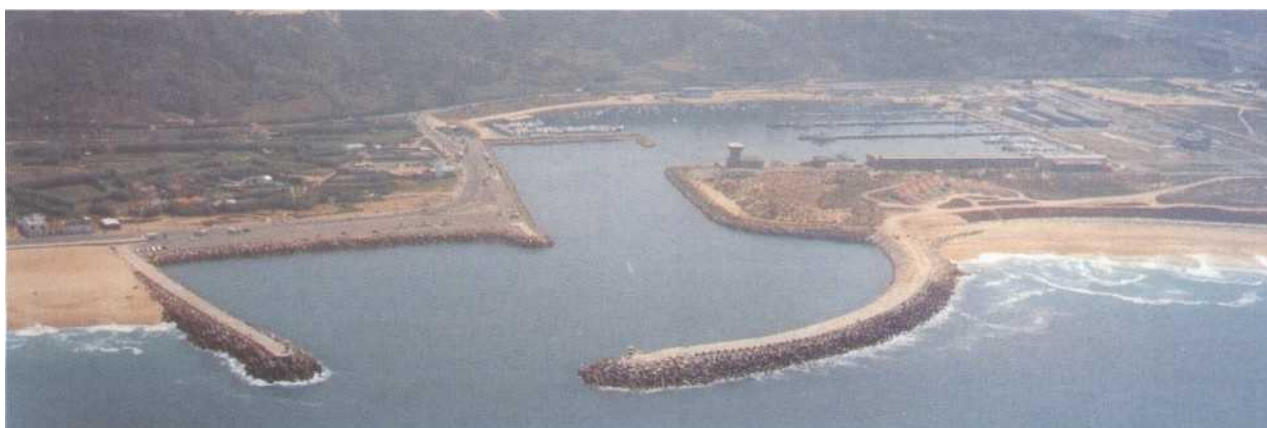
Le port bien dessiné de Nazaré dont on dit que la houle n'y entre pas et qu'il n'est jamais fermé. Sur la photo, prise du nord-ouest, la petite marina est au fond à droite.
