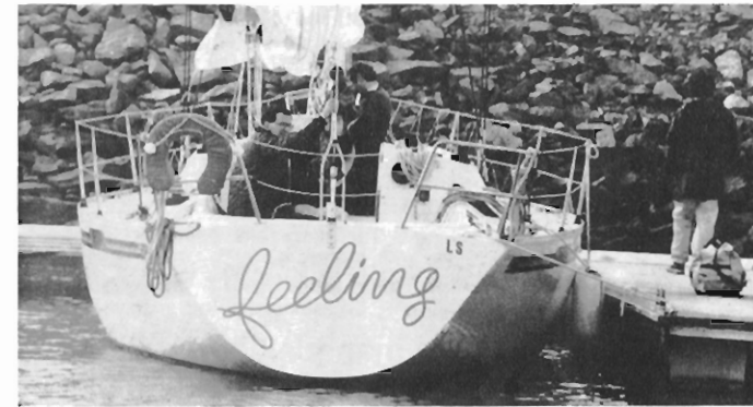
L'importance des volumes arrière autorise des cockpits confortables avec de larges plats-bords.
