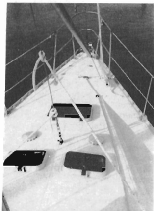
La baille à mouillage du Sun Shine est dotée d'une fermeture efficace.
