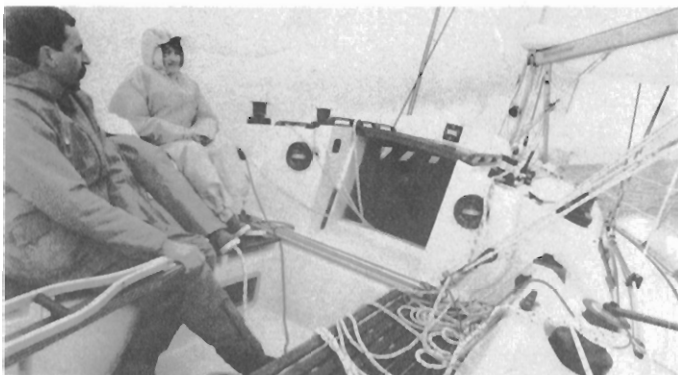
Une bonne disposition de l'accastillage dans le cockpit du Feeling.
