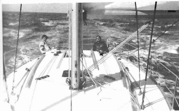
La position rentrée des haubans (Sun Shine) laisse de la place pour circuler.
