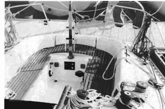
Le cockpit du Gib'Sea est l'un des seuls, avec celui du Feeling, à disposer de banquettes de bois ajourées ne retenant pas l'eau.
