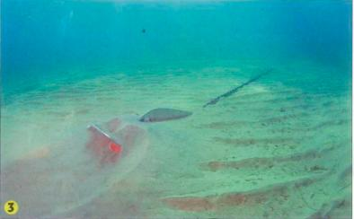
Avec sa pointe lestée, la Brake s'enfouit rapidement (2) et travaille correctement. Techniquement, elle fonctionne, mais elle est sous-dimensionnée et sa pelle a moins de surface que les autres, ce qui tend à fausser la comparaison.
