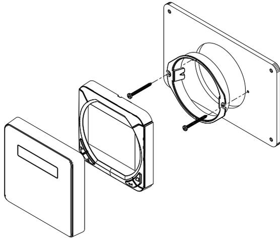
Utilisez le gabarit de perçage pour réaliser le trou de fixation. En même temps, marquez les trous à percer correspondant aux fixations. Pour découper le trou de montage, soyez le plus précis possible, car la bague de fixation doit s'ajuster au mieux dans le trou, sans toutefois être trop serrée. S'il faut appuyer sur la bague pour la mettre en place, il est fortement probable qu'elle se tord et qu'elle ne maintienne pas suffisamment l'écran.
