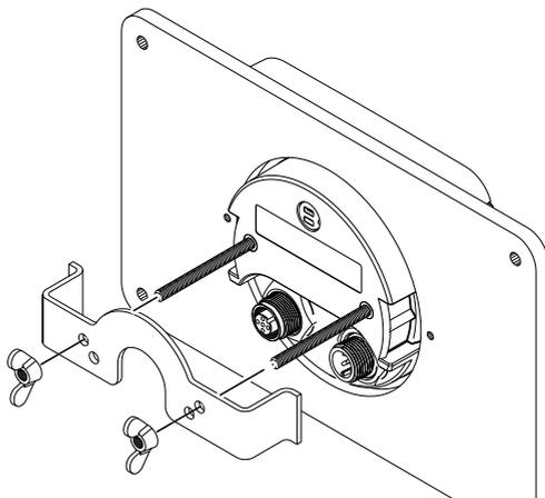
Avant d'ajuster l'écran en position de montage, vissez solidement à la main les tiges filetées au dos de l'écran.
