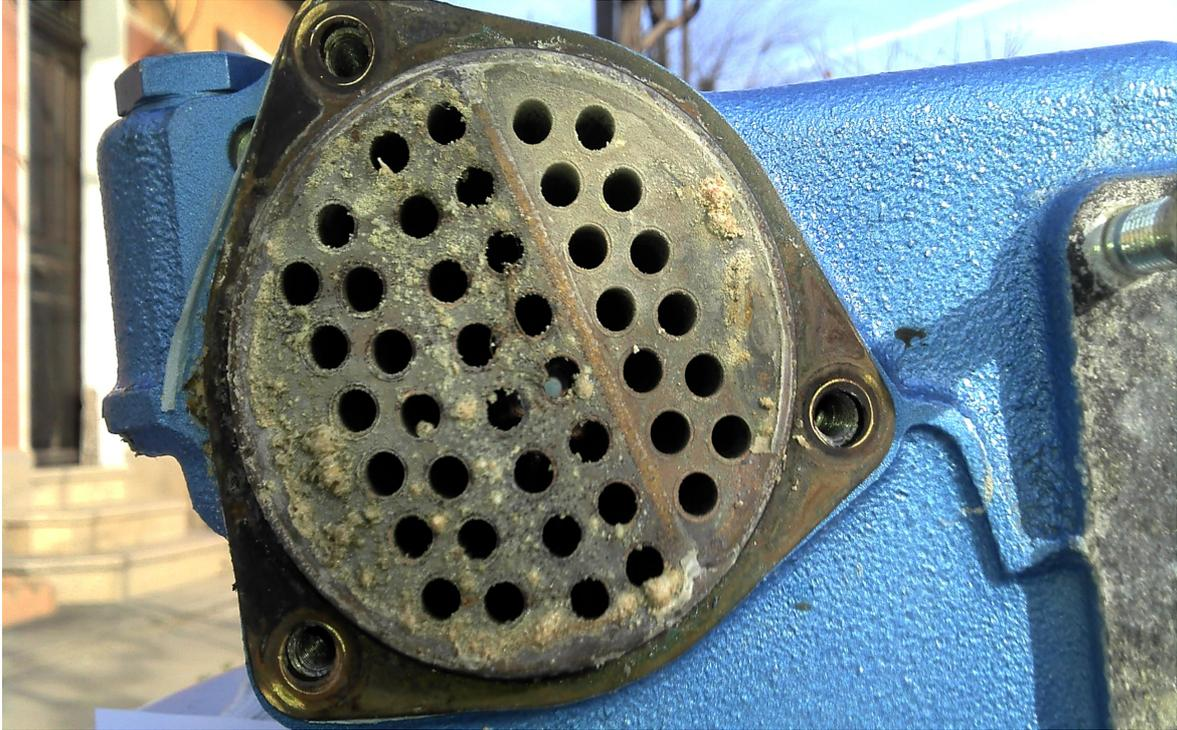
Pour extraire le faisceau j'intercale une plaque de téflon bien à plat et tapote avec un marteau léger
