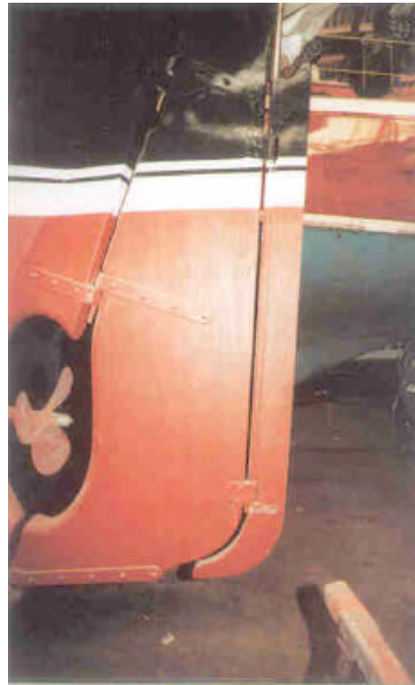
Rapport de taille flettner/ safran principal : ce système peut gêner la marche arrière au moteur.
