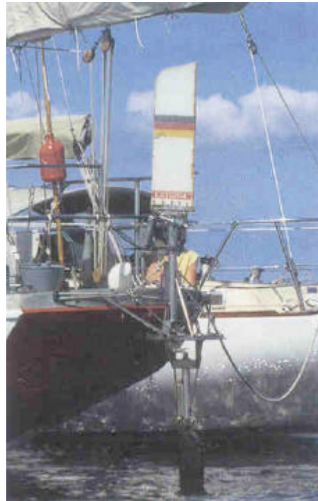
Windpilot Pacific à girouette horizontale en inox 1974
