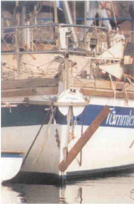
Safran pendulaire Atoms hors d'usage
