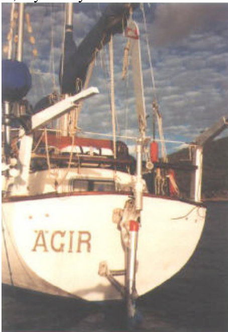
Des bossoirs sont parfaitement compatibles avec un Pacific Plus, comme en témoigne ce HR 41 à Papeete.
