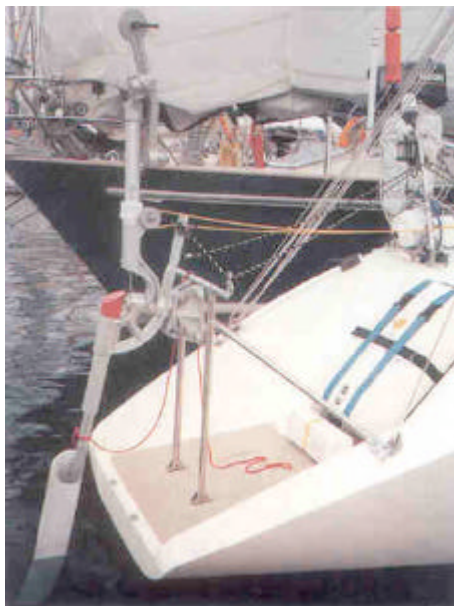
Bâti support sur un Helmsman 49
