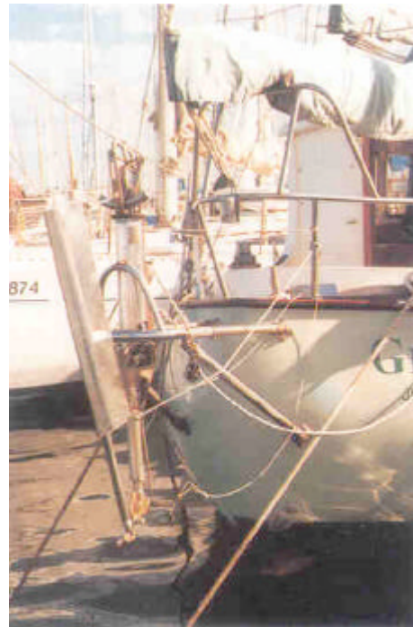
Safran pendulaire Fleming hors d'usage
