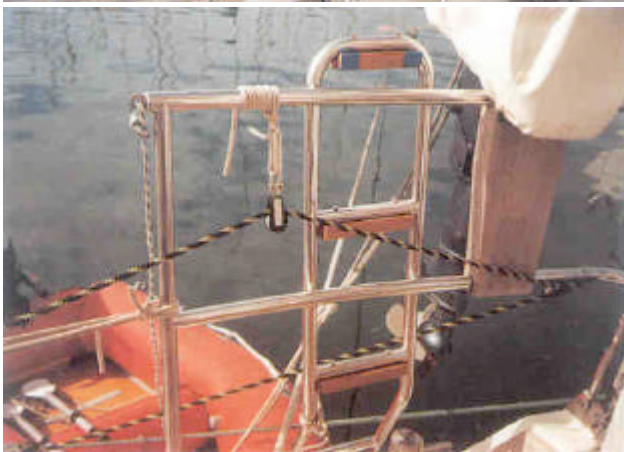
Poulie supplémentaire permettant de tendre aisément les drosses.
