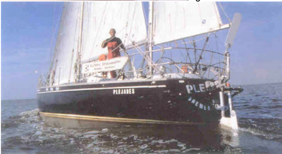
Un artimon dont la bôme dépasse du tableau risque de gêner la girouette.
