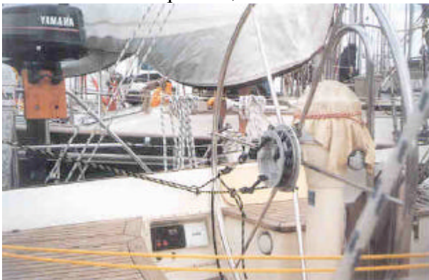
Drosses réunies du même côté et groupées à l'aide de mousquetons.
