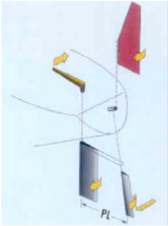
9 Système à girouette verticale et safran pendulaire assisté + flettner
