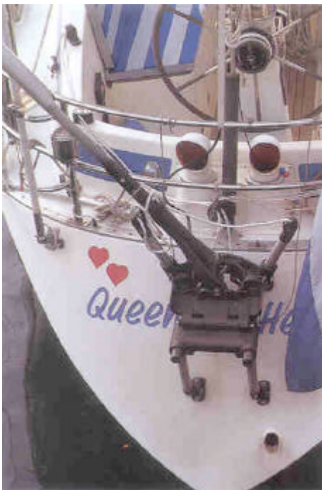
Safran pendulaire Aries Lift-Up hors d'usage
