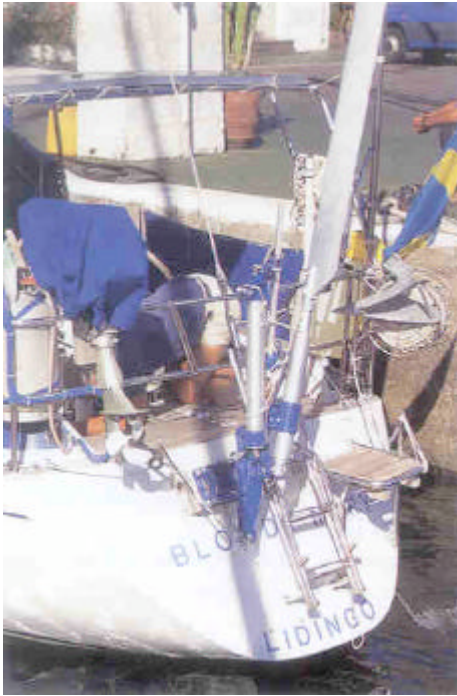
Safran pendulaire Sailomat 601 en position relevée
