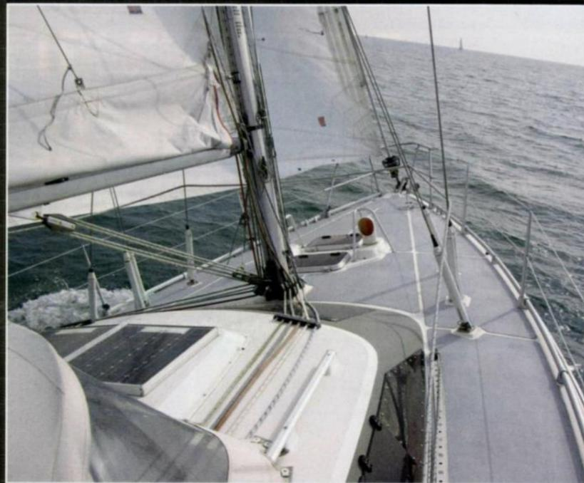
▲ Deux panneaux solaires sont placés en arrière du mât, sur le rouf panoramique.
