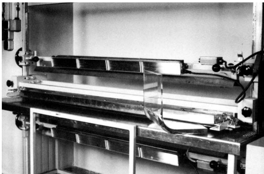
Figure 6 : Banc chauffant avec différents radiateurs à infrarouges et pièce de PLEXIGLAS® pliée
