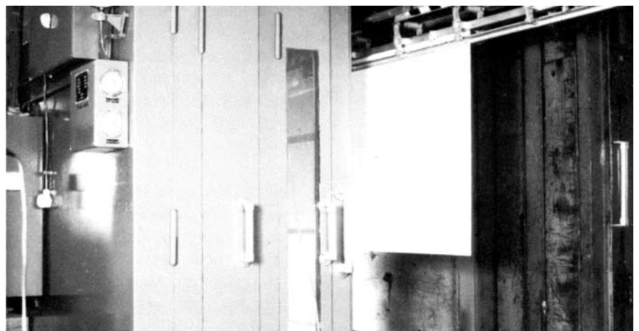
Figure 5 : Introduction dans l'étuve d'une plaque de PLEXIGLAS® suspendue
