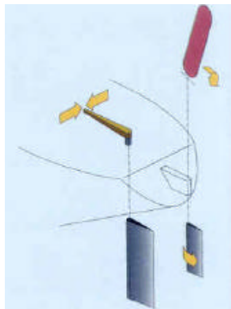
4 Système à girouette horizontale et safran auxiliaire
