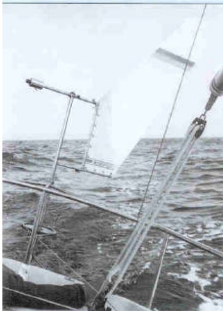
Système à girouette verticale à bord d'un bateau de 5m/16ft du designer Van de Stadt.
