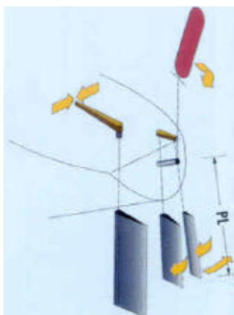
12 Système à girouette horizontale et double safran
