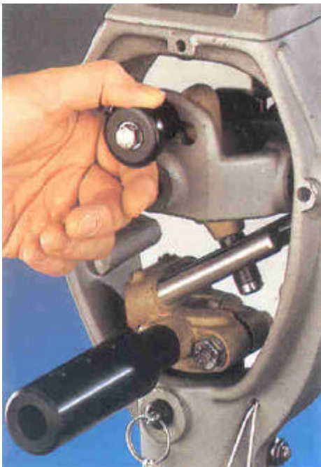
Transmission à démultiplicateur Hydrovane pour un meilleur amortissement
