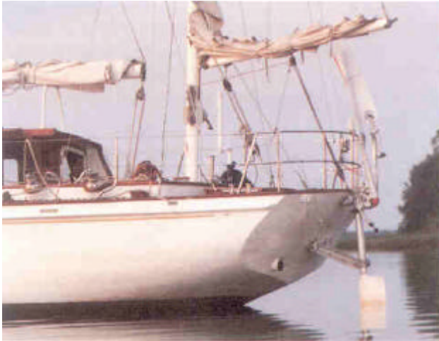
Un artimon dont la bôme dépasse du tableau risque de gêner la girouette.
