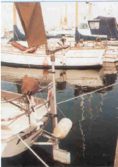
Régulateur d'allure RVG à girouette verticale et safran
