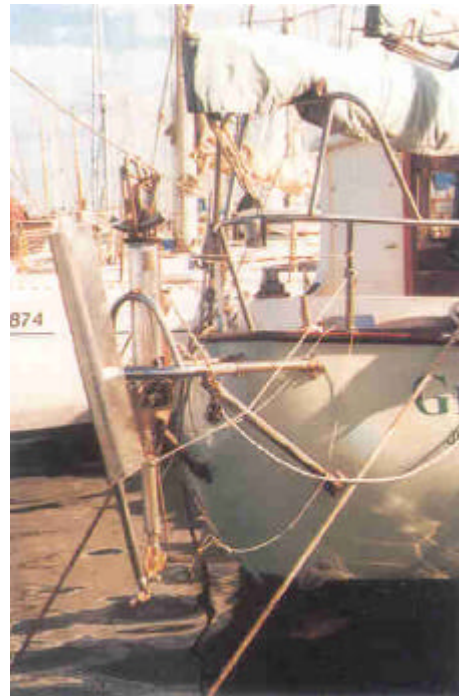
Safran pendulaire Fleming hors d'usage
