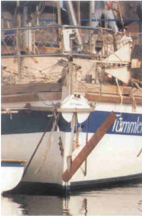
Safran pendulaire Atoms hors d'usage
