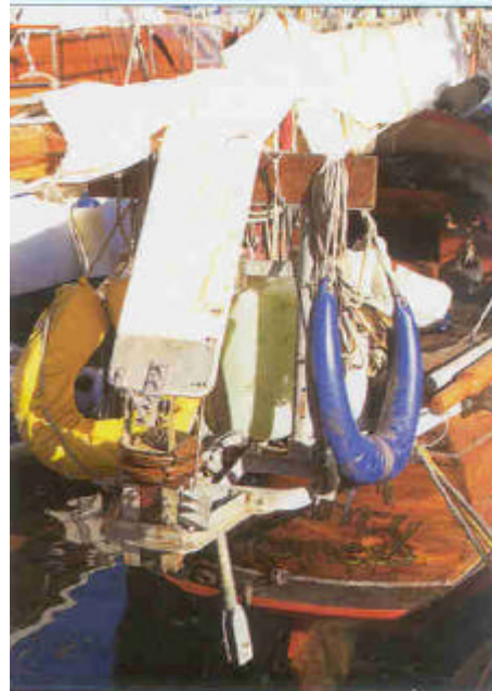
Système à girouette horizontale QME. Ce système est plus une solution d'appoint que de pilotage à part entière.
