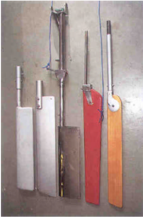
Dispositifs de protection contre les surcharges (de gauche à droite) : Aries, Sailomat, Monitor, Windpilot Pacific (ancien modèle), Windpilot (nouveau modèle)
