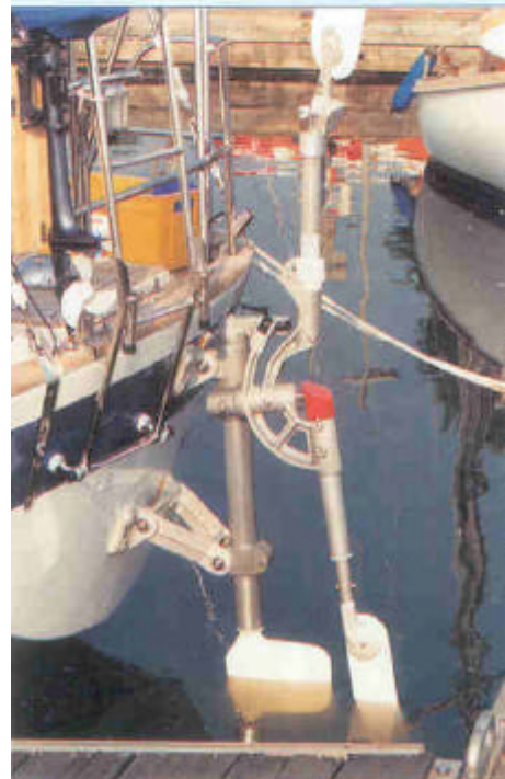
Régulateur d'allure à double safran Windpilot Pacific Plus monté sur un Hallberg Rassy 36.
