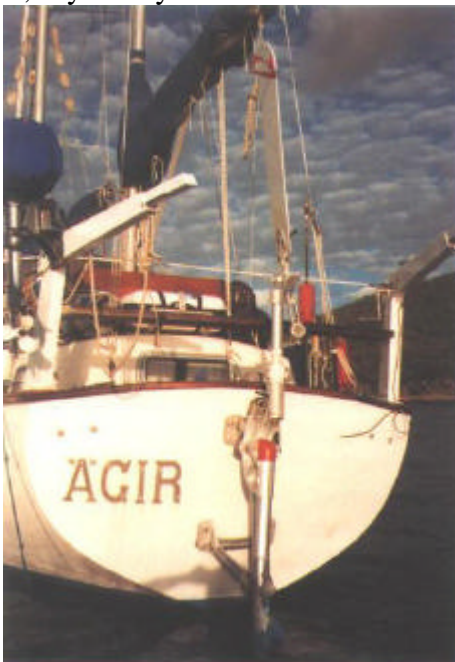
Des bossoirs sont parfaitement compatibles avec un Pacific Plus, comme en témoigne ce HR 41 à Papeete.
