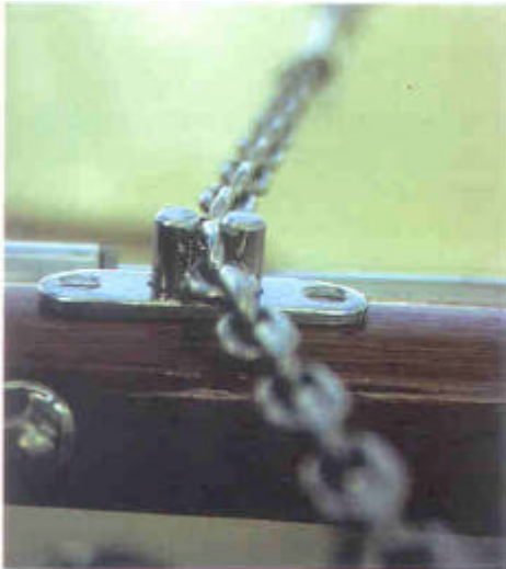
Adaptateur de barre franche et chaîne de raccord, Windpilot Pacific
