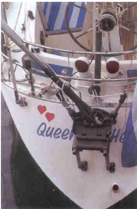
Safran pendulaire Aries Lift-Up hors d'usage
