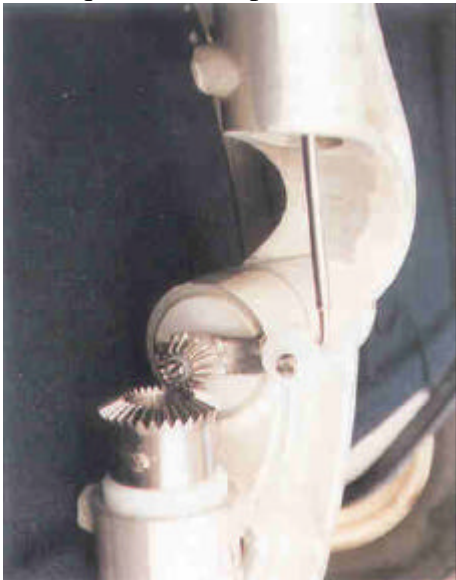
Engrenage conique 2:1 tournant sur 360° d'un régulateur d'allure Windpilot Pacific
