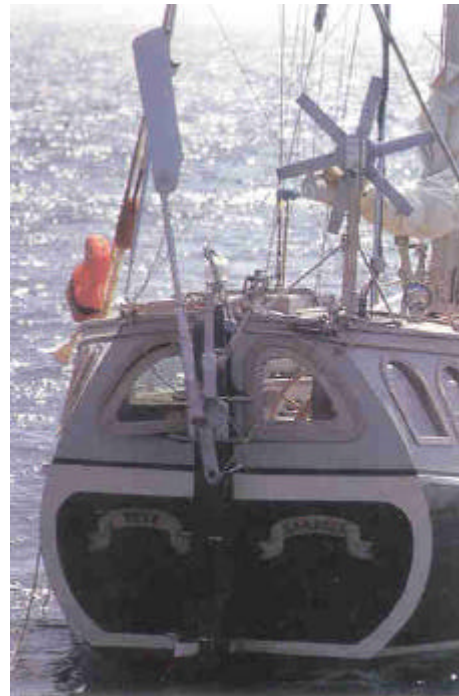
Safran pendulaire Windpilot Pacific en position relevée
