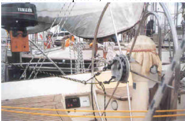
Drosses réunies du même côté et groupées à l'aide de mousquetons.
