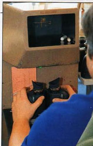
**Alignement.** Les deux optiques des jumelles doivent produire une image la plus alignée possible.
