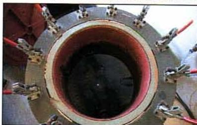
**Plouf!** Les jumelles trempent dans cette «bassine» fermée d'un couvercle. Une pression d'air est alors exercée pour simuler la profondeur (0,2 bar pour -2m).
