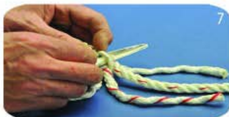
Passage des torons pour la première passe : 3 ème toron
