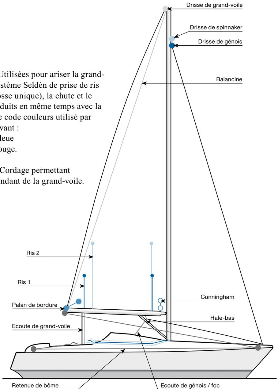
**Balancine :** Utilisée pour retenir l'extrémité de la bôme lorsqu'elle n'est pas maintenue par la grand-voile et lui éviter de tomber dans le cockpit, notamment lors des prises de ris.
