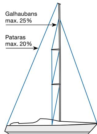
Ce type de gréement est très exigeant car il est très complexe à régler et à utiliser. En général, ce type de gréement requiert plus de tension dans les haubans qu'un gréement avec des barres de flèche non poussantes. La tension de l'étau est affectée par trois éléments :
