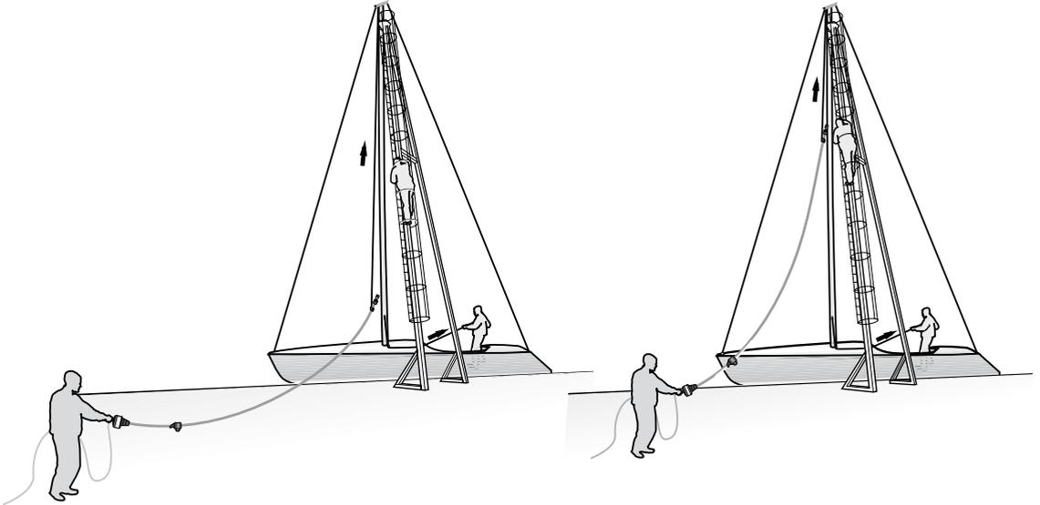
Normalement, l'enrouleur de génois est placé sur la face avant lors du mâtage. Une personne est désignée pour éviter que l'enrouleur n'abîme le mât ou le bateau. Le profilé utilisé supporte des rayons de courbure importants, mais peut casser en cas de flambage incontrôlé.
