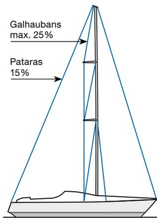
Ce type de gréement est très exigeant car il est très complexe à régler et à utiliser. En général, ce type de gréement requiert plus de tension dans les haubans qu'un gréement avec des barres de flèche non poussantes.
