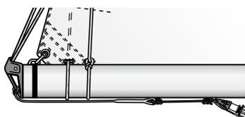
*Afin de faciliter l'utilisation d'une retenue de bôme, une estrope peut être installée de façon permanente entre l'embout de la bôme et le coulisseau de hale-bas. Fixer l'estrope sur l'embout de bôme, faire un œil épissé à l'autre extrémité sur lequel sera fixé un sandow. Au repos, le mou de l'estrope sera repris en tendant le sandow.*
