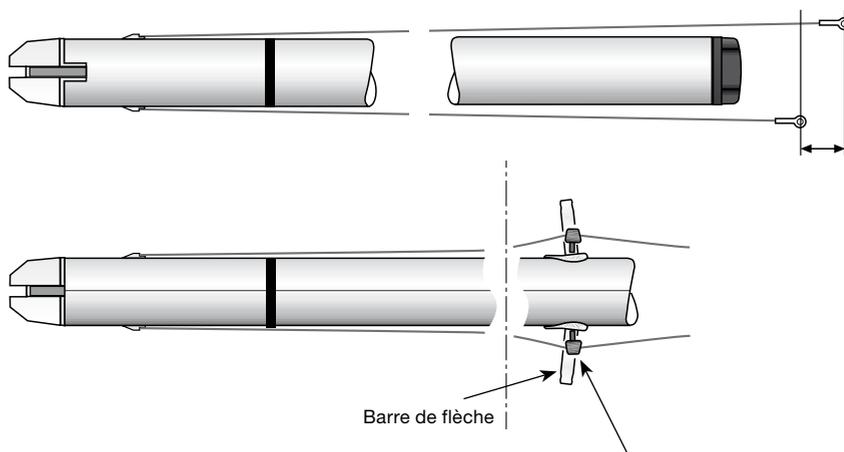
Embout à fixer au niveau des ancrages des barres de flèche, sur les haubans tendus le long du mât. L'angle vertical final des barres de flèche doit toujours être de 6°.
