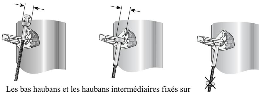
Les bas haubans et les haubans intermédiaires fixés sur la ferrure de barre de flèche possèdent un embout à boule à leur extrémité supérieure. Cet embout, placé dans le logement de la ferrure de barre de flèche possède plusieurs coupelles. L'utilisation d'une ou deux de ces coupelles permet une adaptation correcte à la dimension du logement. Mesurer la largeur de l'ensemble complet, y compris les coupelles pour s'assurer que toutes les coupelles sont correctement positionnées.
