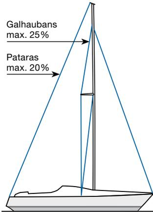
En général, ce type de gréement nécessite plus de tension dans les haubans qu'un gréement avec barres de flèche non poussantes. La tension de l'étai est affectée par trois éléments :
