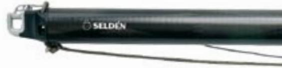
*Tangon de spinnaker carbone (dimensions 76/76 et 88/88 avec petits embout composite et pantoire en Dyneema.*
