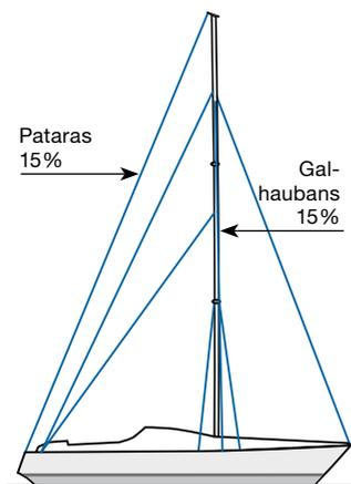
Des bastaques sont nécessaires pour obtenir une stabilité longitudinale suffisante et obtenir la tension voulue sur l'étai. Les pataras doivent être fixés aussi près que possible de l'axe longitudinal de la coque, de façon à ne pas affecter le réglage latéral. Ce type de gréement se rencontre aussi avec bas haubans simples, dans ce cas des basses bastaques sont recommandées pour contrôler un cintrage excessif du mât.
