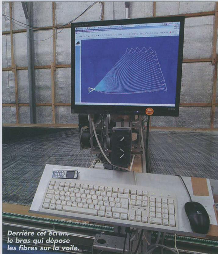
Derrière cet écran, le bras qui dépose les fibres sur la voile.
