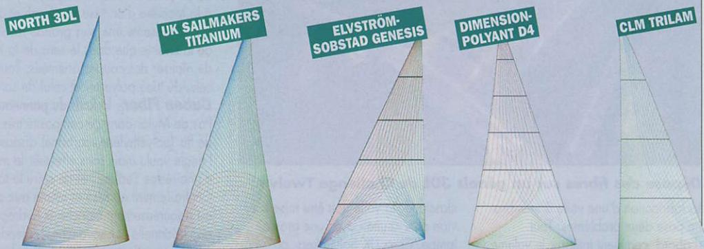
**Cinq manières de fabriquer une voile à membrane, dont deux (3DL et Titanium) permettant de réaliser la voile d'un seul tenant, sans couper les fils. North utilise un moule, alors que UK intègre le volume en déposant les fils à plat. Chez Elvström, CLM et Dimension, on lamine séparément des panneaux que l'on assemble ensuite.**
