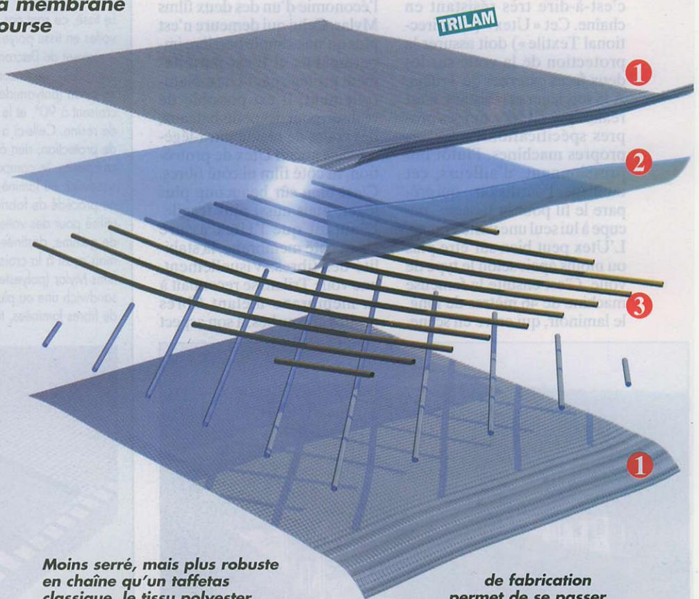
Moins serré, mais plus robuste en chaîne qu'un taffetas classique, le tissu polyester « unidirectionnel », ou « Utex » (1), protège d'un côté le film Mylar (2), de l'autre côté les fibres de la membrane (3) sur lesquelles il est directement laminé. Ces fibres sont pour la plupart droites, sauf dans certaines zones où l'on pose quelques fils courbes. Ce procédé
