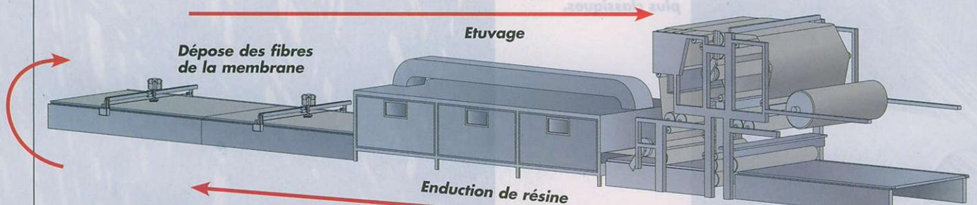
Cette fameuse machine assure à la fois le laminage (à droite), la dépose des fibres (à gauche), l'enduction de résine et l'étuvaage (au centre). Le film Mylar et le tissu polyester externe de protection (dit « Utex ») sont tout d'abord laminés
