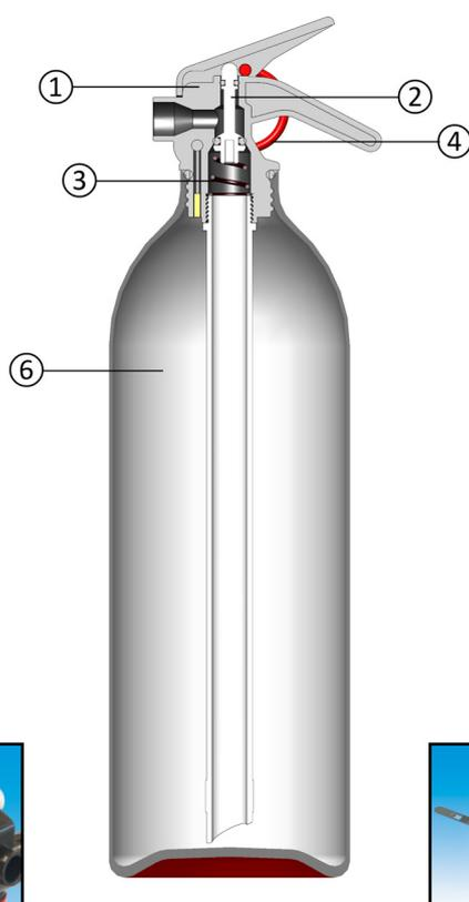
① La vanne est constituée de résine acétal en assurant une protection parfaite contre la corrosion.
