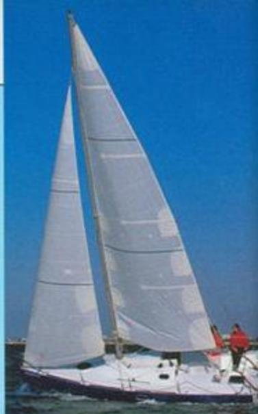
Le plan de voilure avec un foc étroit facilite le travail de l'équipage au louvoyage.
