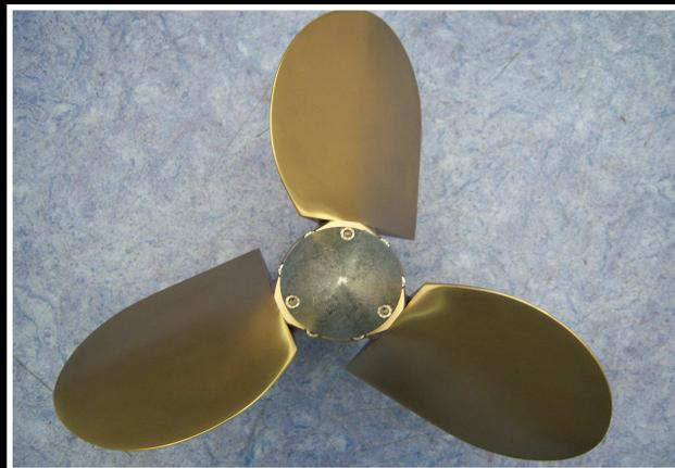
EN FIN DE COURSE, L'ANGLE DES PALES DOIT ÊTRE CELUI CALCULÉ ET IDENTIQUE POUR LES TROIS PALES (VOIR PHOTO CI-CONTRE).
