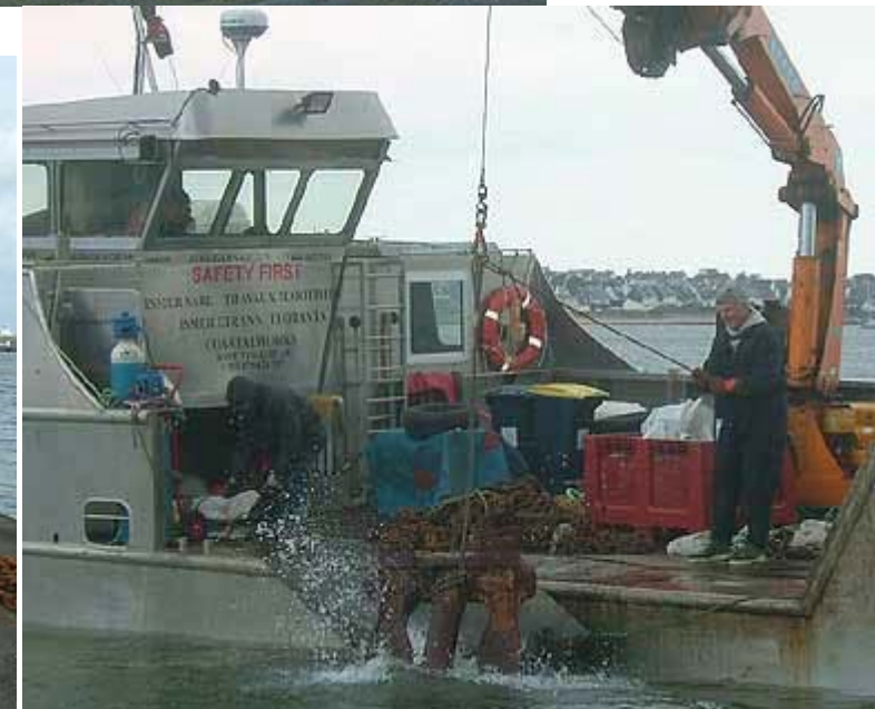
Remise en service d'un ponton brise-clapot lourd sur 4 ancrs d'1T5 après rupture du pieu Handling of harbour equipments.
