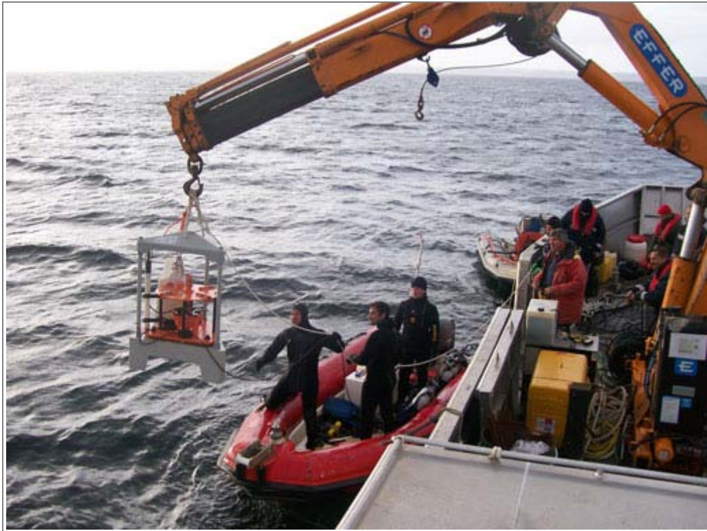
Mesures acoustiques frégate " FORBIN" mise en place d'antennes de mesure acoustique sous-marine
