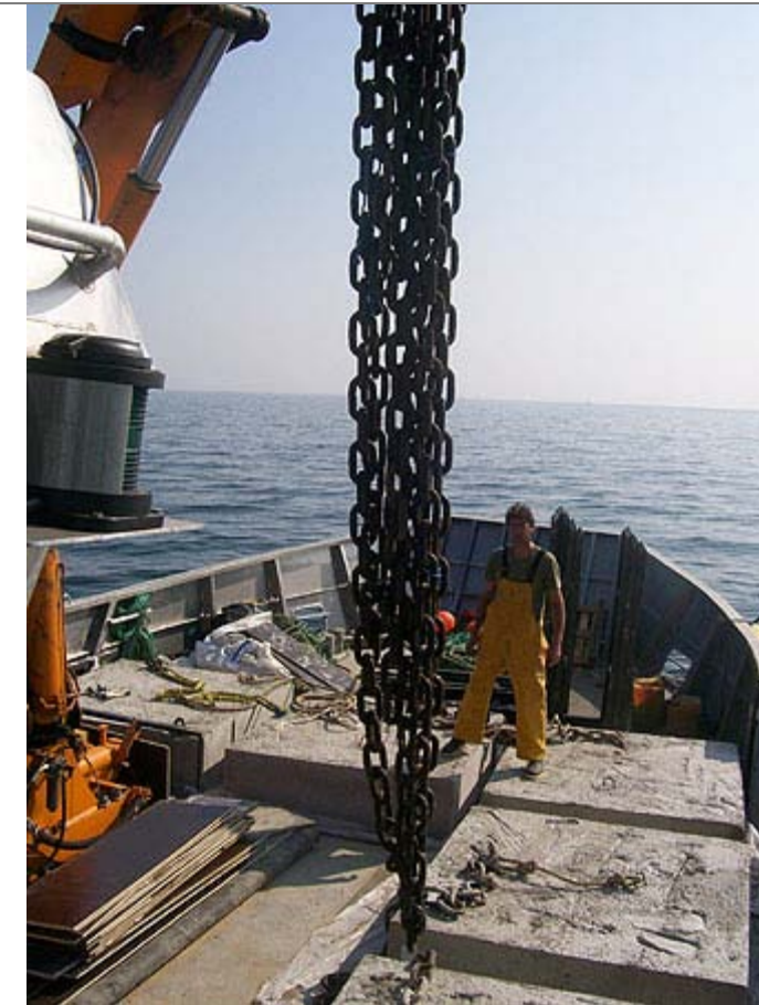
Mouillages lourds - Chaîne traversière de 30 mm pas de 4 ou 5 d (1,680 kg / les 100 mm)
