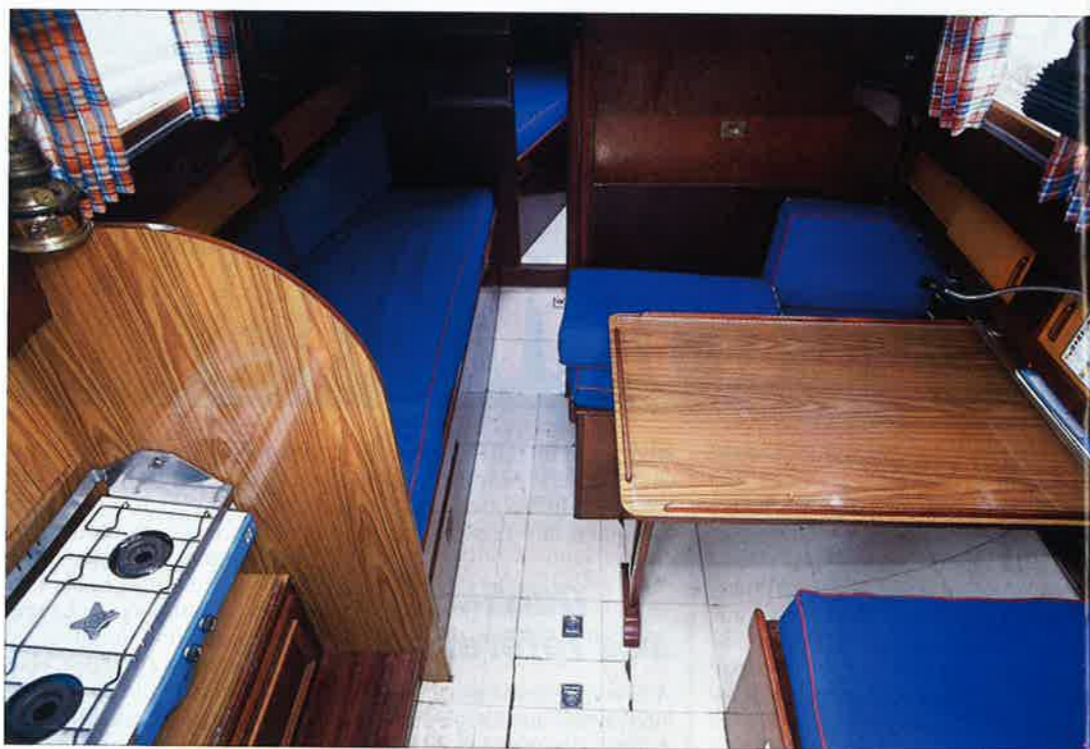
La table du carré, perpendiculaire à la marche, fait également office de table à cartes. Elle fait face à la couchette, la seule du bord pouvant être utilisable sous voiles.
