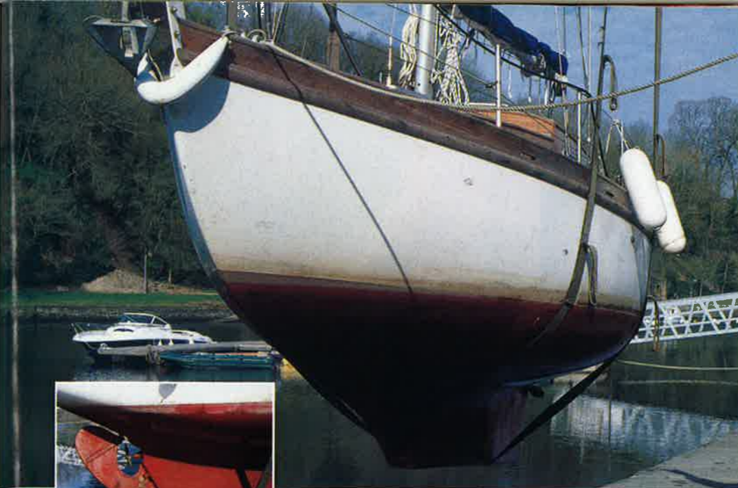
A l'image des croiseurs des années soixante, le safran se situe dans le prolongement de la longue quille.
