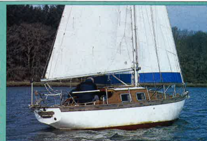
Le tableau arrière est toujours équipé de son régulateur d'allure, le modèle Navik de chez Plastimo.
