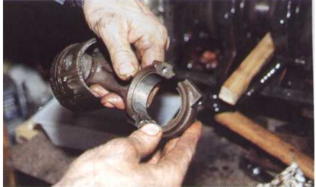
6 Remarquez le sens d'assemblage, ergotage contre ergotage.
