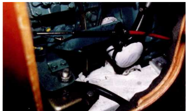
4 Pour dévisser le filtre à huile utilisez une clé à filtre.
