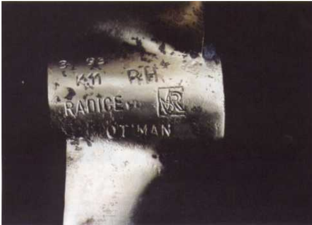
9 - 10 Après un bon nettoyage apparaît le nom du fabricant, le sens de rotation,
