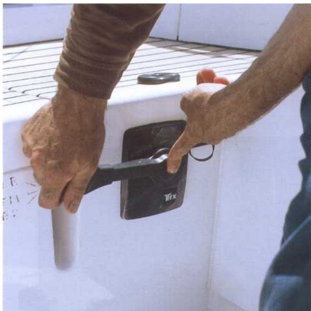
Vérifiez le bon fonctionnement des commandes moteur.
