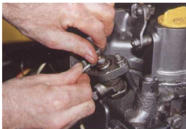
2 Récupérez les joints en cuivre d'étanchéité.
