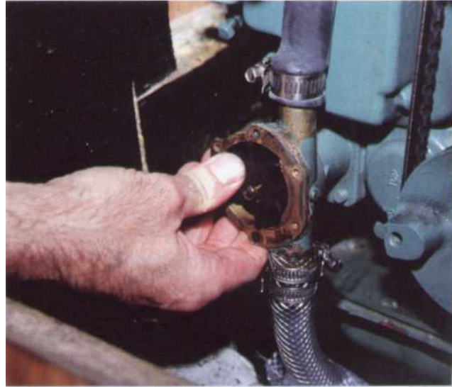
9 Humidifier la turbine avec de l'eau savonneuse puis replacez la turbine dans le corps de pompe en respectant son sens de rotation. Veillez à la bonne orientation des pales.
