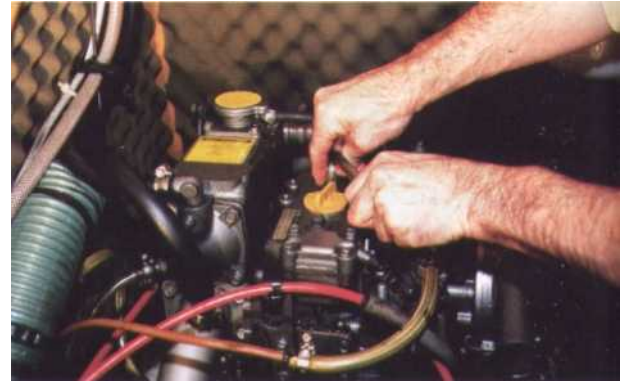
1 Dévissez les vis et déposez le cache-culbuteurs en débranchant les éventuels reniflards qui y aboutissent.
