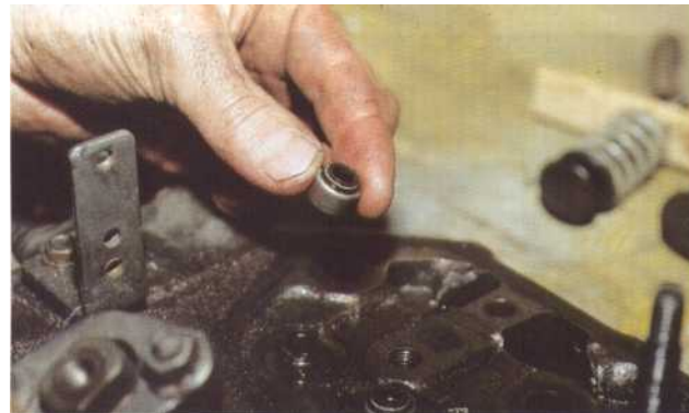
9 Le joint, monte sur sa partie supérieure du guide, supprime l'aspiration de l'huile, au temps admission à travers le guide et la queue de la soupape. Il limite donc la consommation d'huile. A ce titre, il doit être remplacé chaque fois qu'il a été déposé.
