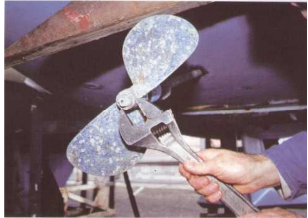
4 Calez l'hélice avec une grosse cale de bois sur la coque, puis dévissez l'écrou.
