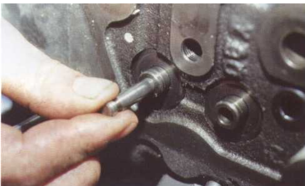
10 La queue de la soupape est soumise à l'usure de même que le guide. Pour vérifier le degré d'usure, enfiler la soupape dans son guide tout en la maintenant ouverte et levée d'un centimètre environ. Si vous pouvez remuer latéralement la soupape et que vous sentez du jeu, la queue de la soupape ou le guide sont usés. Répétez l'opération avec une soupape neuve. Si le jeu a disparu, la queue de la soupape est usée, dans le cas contraire, c'est le guide qui est usé.
