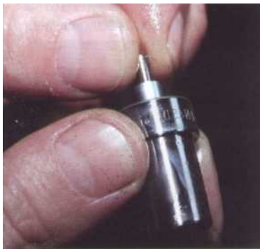
2 Séparez les différentes pièces dans un bac propre, rempli de gazole.
