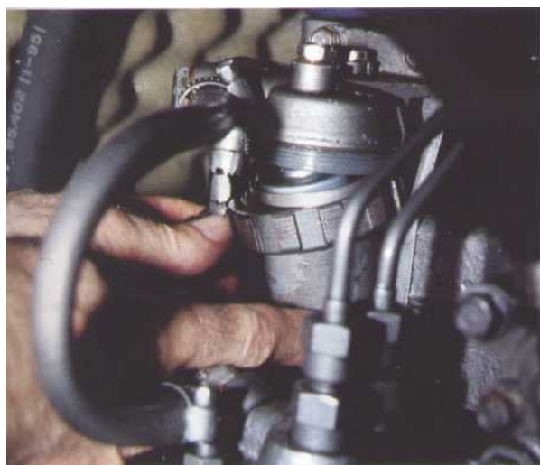
3 Dégagez la cuve en l'inclinant légèrement.
