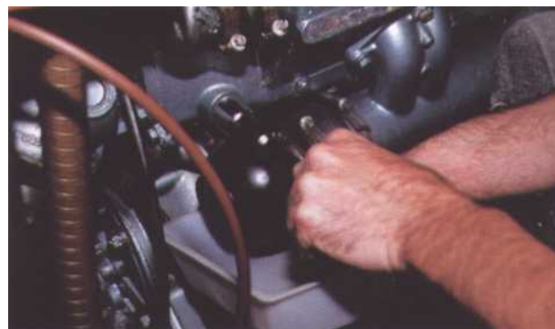
2 Dévissez la vis, placez un récipient sous l'orifice de vidange afin de modifier la trajectoire du jet et limiter les salissures.
