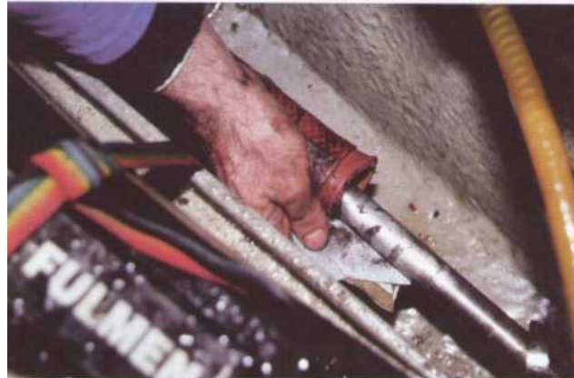
4 Après un bon nettoyage de cale, nettoyez et contrôlez l'arbre d'hélice, la durit de raccordement ainsi que ses colliers. Remarquez les traces de corrosion au niveau de l'emplacement des garnitures. L'arbre est piqué.
