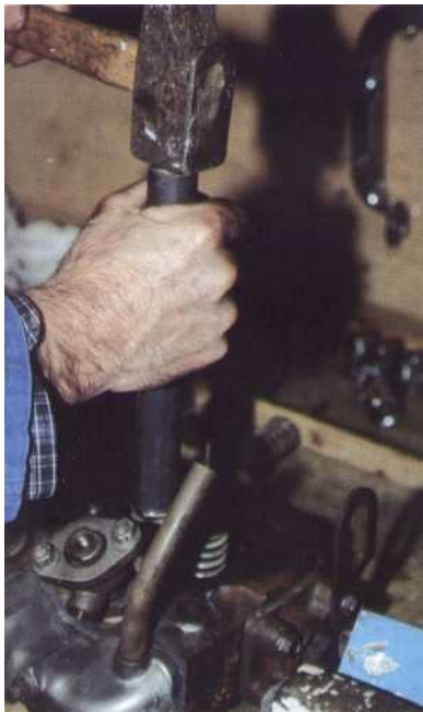
5 Même si vous ne disposez pas d'un démonte-soupape, il est tout à fait possible de procéder à l'opération en frappant avec un gros marteau sur un tube disposé sur la cuvette supérieure de la soupape.
