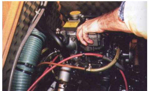
2 Si celui-ci reste collé, libérez-le d'un coup de maillet en bois. N'intercalez jamais un tournevis entre les plans de joint.
