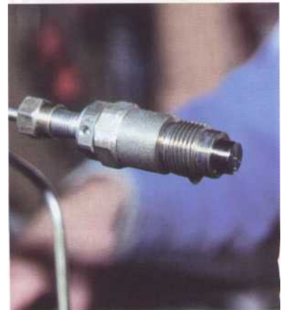
8 Après l'essai de pulvérisation, essuyez le nez de l'injecteur pour vérifier l'étanchéité de l'injecteur. Maintenez la pression 10 bars en dessous de la pression de déclenchement. Si vous constatez la formation d'une goutte, remplacez l'injecteur.
