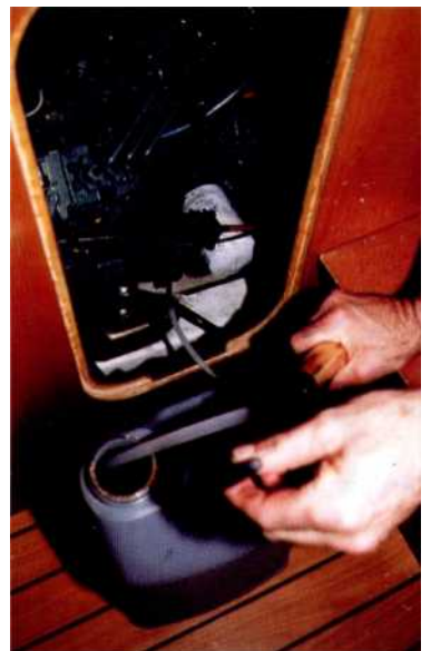
3 Pompez jusqu'à épuisement l'huile contenue dans le carter moteur. La vidange s'effectue moteur chaud pour faciliter l'aspiration de l'huile
