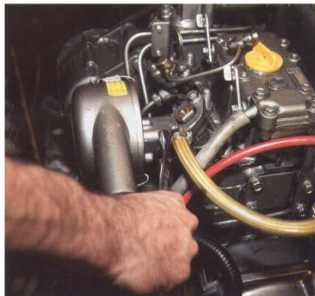
2 Dévissez les tuyaux haute pression.
