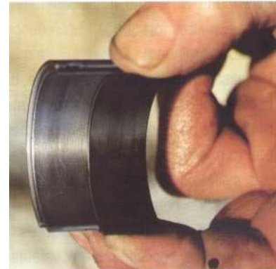
8 L'examen des coussinets laisse apparaître la couche de métal rose, signe d'une usure prononcée.
