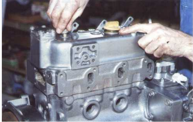
8 Remontez le joint de cache-culbuteurs avec un joint neuf. Collez-le éventuellement, côté cache-culbuteurs, avec un peu de pâte à joint ou de graisse pour le maintenir en place.
