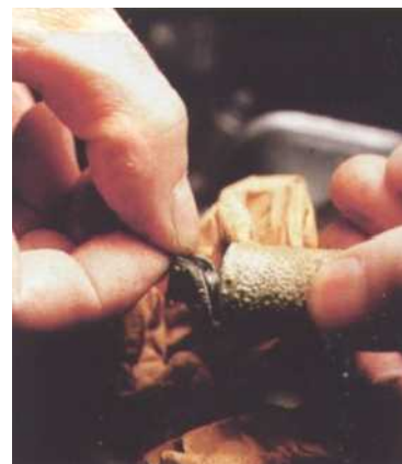
2 Dévissez: l'ancienne anode de son support Veillez à récupérer son joint d'étanchéité (Yanmar)
