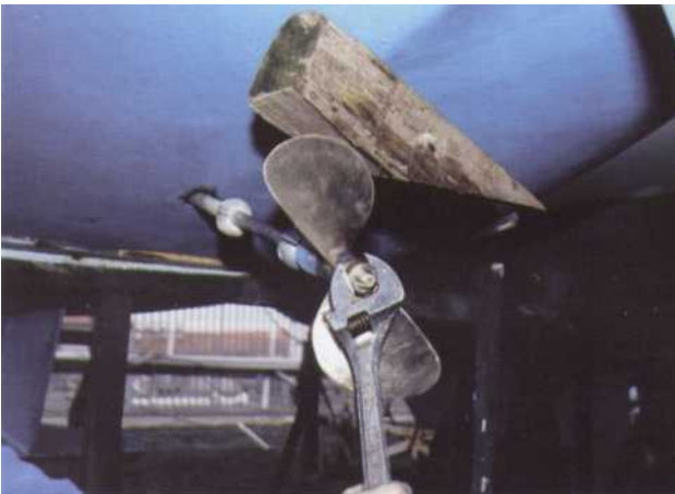
11 Reposez la clavette après vous être assuré de son bon état. Celle-ci ne doit pas être ni déformée ni marquée. Reposez l'hélice, vissez l'écrou sur un nouveau frein, puis bloquez l'hélice en procédant de la même façon que lors du débloccage.
