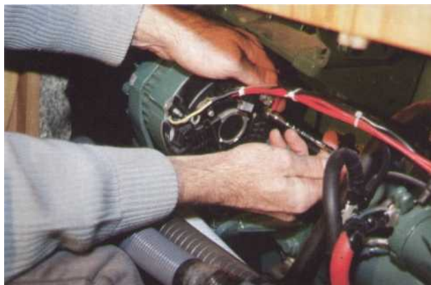
2 Déconnectez ensuite chacun des fils. Revissez les écrous sur leurs vis respectives.
