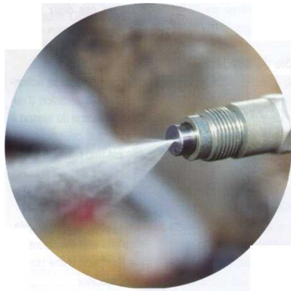
7 Il est possible de visualiser à ce stade le fonctionnement de l'injecteur en le remontant retourné sur le tuyau haute pression. Chambres de combustion enlevée, actionnez le décompresseur et faites tourner le moteur au démarreur. L'injecteur doit pulvériser un fin brouillard de gazole.
