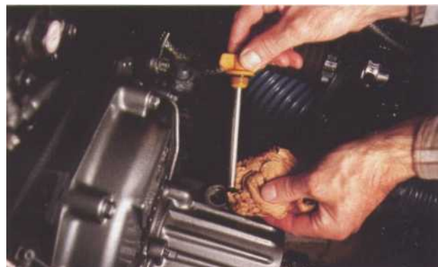
2 Essuyez une première fois la jauge avant de la replonger dans l'inverseur.
