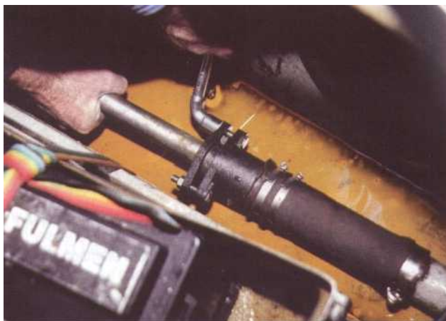
1 Dévissez le fouloir. Remarquez la quantité et la couleur de l'eau dans la cale, fuite d'eau, fuite d'huile. Un bon nettoyage et une bonne révision s'imposent.
