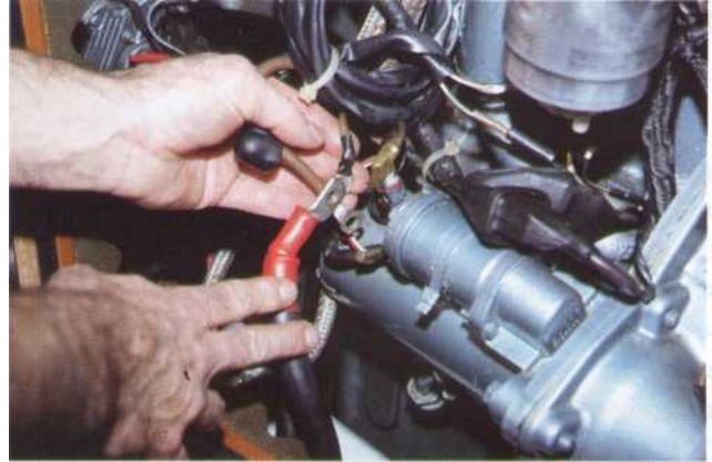
3 Déconnectez chacun des fils tout en vérifiant l'état des cosses, la propreté mais aussi le sertissage des fils.
