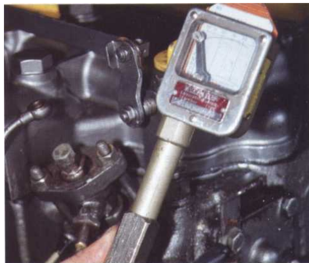
5 Installez le capteur à la place de l'injecteur, serrez la bride.
