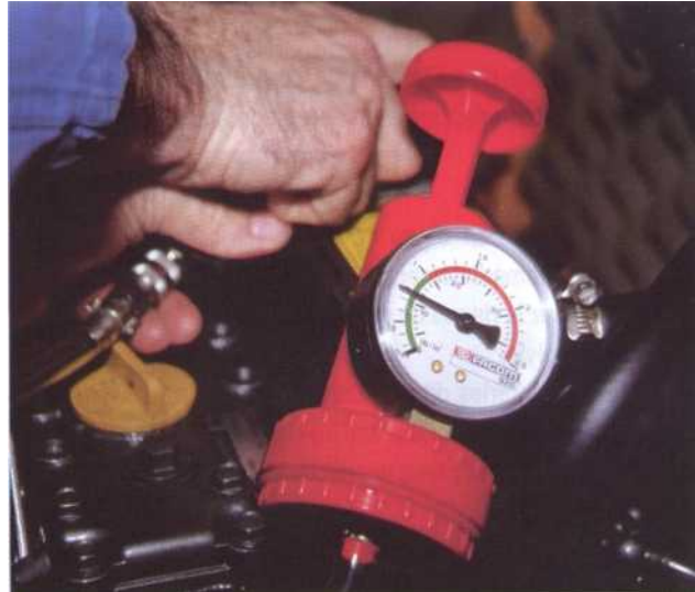
6 Il permet aussi de contrôler la pression d'ouverture du clapet de surpression.
