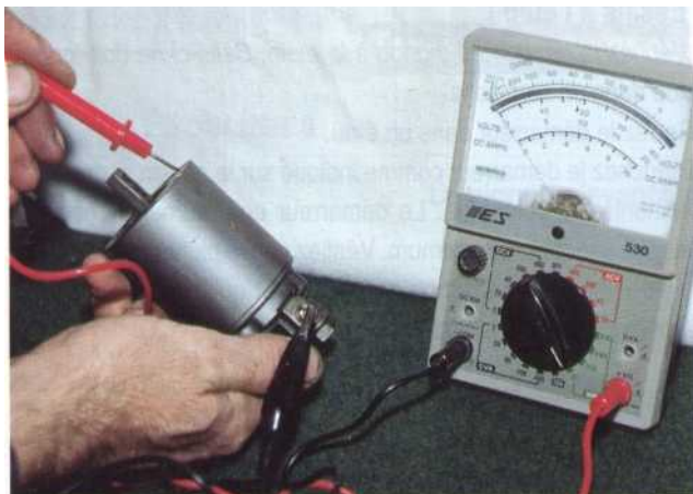
17 Lors du contrôle du solénoïde, vérifiez la bonne continuité de l'enroulement d'attraction et de l'enroulement de maintien. Si la continuité est bonne, les bobinages de maintien et d'attraction sont bons.
