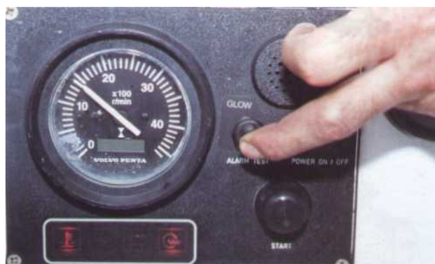
Actionnez la clé ou le bouton faisant office de contact. Les voyants de pression d'huile et de charge doivent s'allumer. Préchauffez puis actionnez le démarreur. Le moteur doit démarrer au bout de quelques secondes et tous les voyants s'éteindre.
