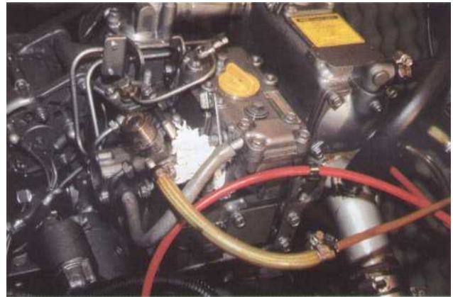
b Obturez le logement de l'injecteur dans la culasse afin d'éviter qu'un corps étranger pénètre dans le moteur.
