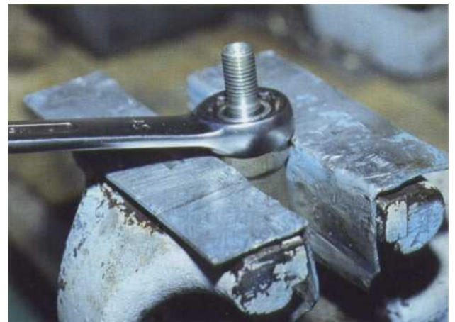
1 Pour désassembler l'injecteur, il est nécessaire de le maintenir dans un étau muni de mordaches.
