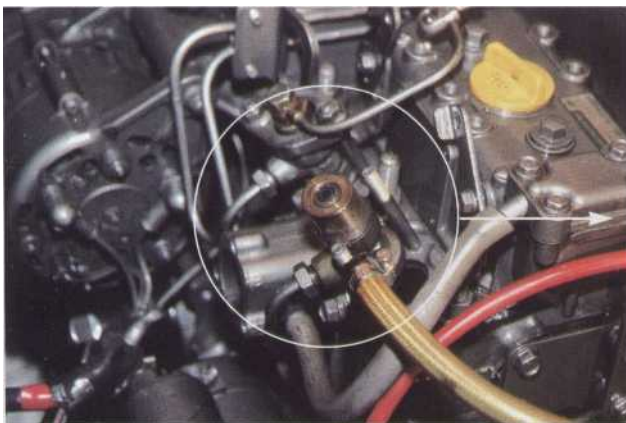
7 Il est possible de visualiser à ce stade le fonctionnement de l'injecteur en le remontant retourné sur le tuyau haute pression. Chambres de combustion enlevée, actionnez le décompresseur et faites tourner le moteur au démarreur. L'injecteur doit pulvériser un fin brouillard de gazole.
