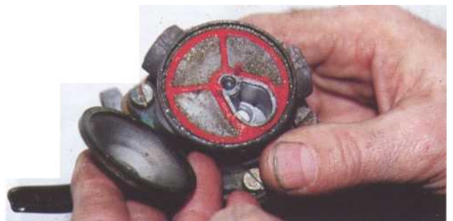
Quelques types de pompes, notamment celles montées sur les moteurs Volvo, possèdent un filtre tamis qu'il est nécessaire de déposer et de nettoyer.
