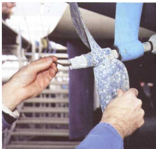
1 Dévisser en premier lieu l'anode. Son blocage est assuré par une vis polygonale mâle. Utilisez une clé Allen.
