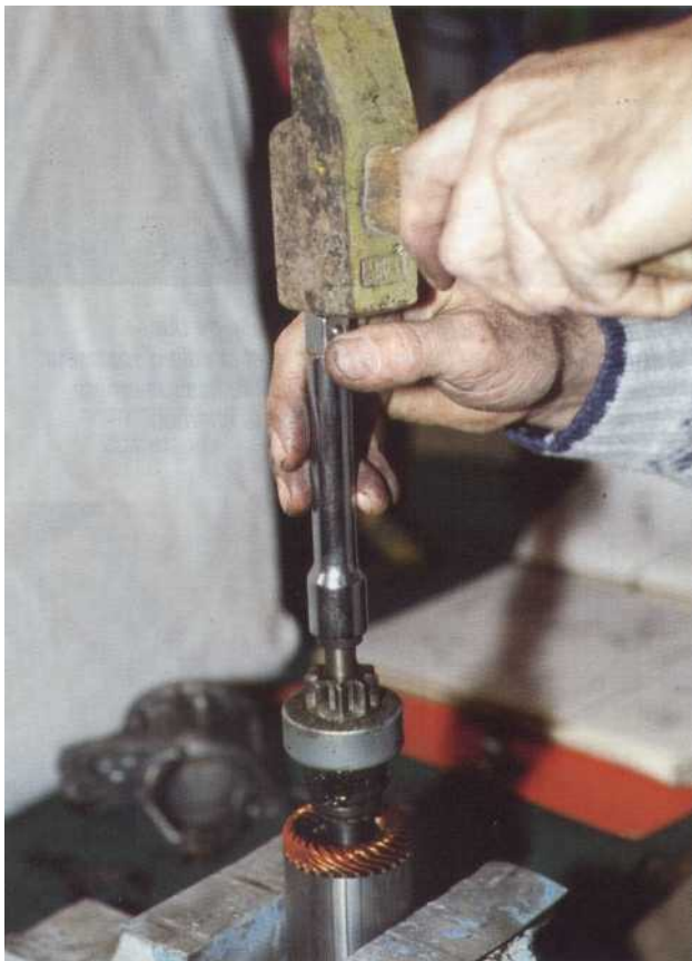
7 Faites sauter la butée du lanceur en arrière du circlip situé à l'extrémité de l'induit côté entraînement. Utilisez pour ce faire un tube possédant un diamètre intérieur légèrement supérieur à celui de l'axe de l'induit. Ici la petite rallonge Facom fait très bien l'affaire.
