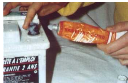
2 Un peu de graisse neutre appliquée sur les bornes limite le sulfatage.
