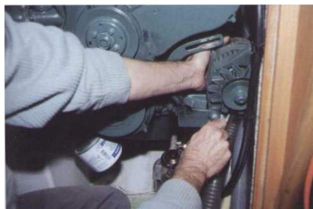
5 Enlevez la vis de réglage puis dégagez l'axe de pivotement tout en soutenant l'alternateur.
