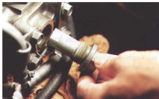
4 Après avoir changé l'anode revissez puis bloquez celle-ci sur le bloc moteur.
