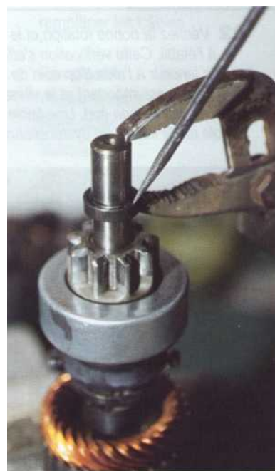
20 Montez en force la butée sur le circlip en se servant d'une ou de deux paires de pinces.
