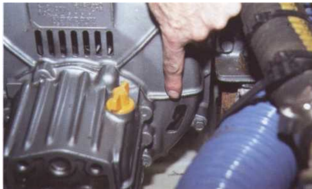
7 Repérez sur le moteur l'emplacement des repères de calage. Sur la photo (moteur Yanmar), une fenêtre créée dans la cloche de l'inverseur permet de le visualiser. Lorsque le repère mobile passe devant le repère fixe, la pompe d'injection est en début d'injection sur le cylindre concerné.
