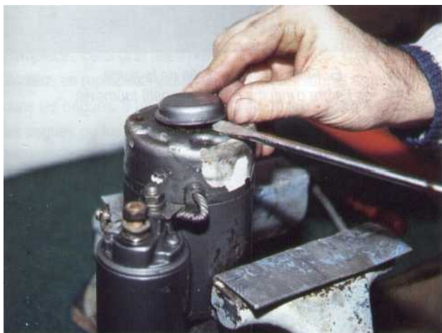
1 Serrez le démarreur dans un étau puis déposez le cache poussière.
