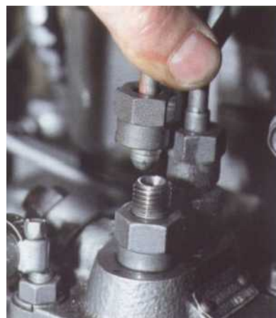
7 Repérez sur le moteur l'emplacement des repères de calage. Sur la photo (moteur Yanmar), une fenêtre créée dans la cloche de l'inverseur permet de le visualiser. Lorsque le repère mobile passe devant le repère fixe, la pompe d'injection est en début d'injection sur le cylindre concerné.
