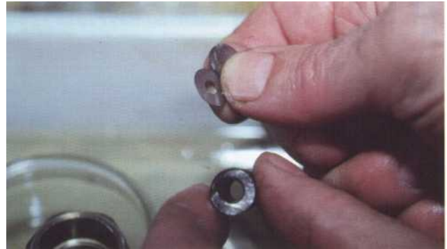
3 L'empilage de petites cales permet d'ajuster la pression d'injection.
