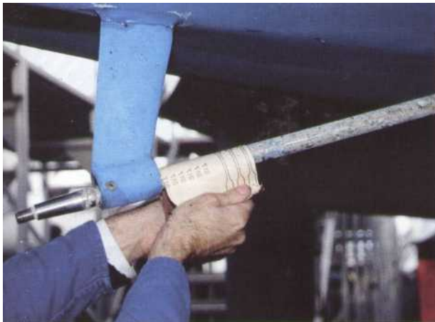
6 Avant de rentiler une nouvelle bague, un petit de nettoyage au papier de verre s'impose.
