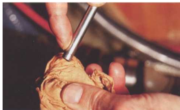
4 Vérifiez que le niveau se situe bien entre le repère minimum et maximum. L'huile n'étant pas polluée - pas de résidus de combustion -, elle est translucide. Soyez attentif, la lecture est quelque fois difficile.
