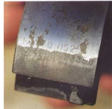
9 Le marquage des coussinets s'effectue sur l'envers de la coquille. Std pour cote standard ou 0,10 - 0,20 pour la cote de rectification.
