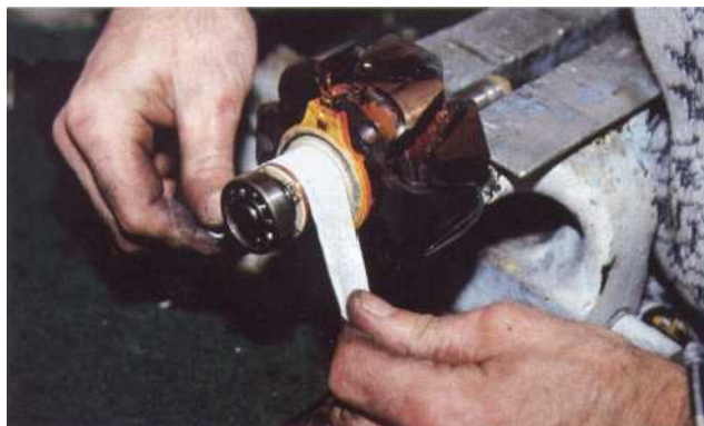
6 Nettoyez les pistes du rotor avec une toile émeri fine. Si les pistes sont creusées, remplacez le rotor.
