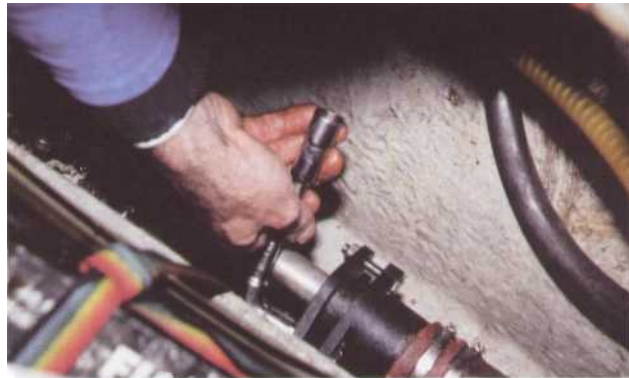
8 Engagez le fouloir et revisser les écrous tout en faisant tourner l'arbre. Celui-ci doit pouvoir s'engager de la valeur de l'épaisseur d'une tresse puis serrez très légèrement le fouloir. Le réglage s'effectue ensuite à flot en plusieurs étapes. Laissez fuir en premier lieu afin d'évacuer l'air prisonnier dans la partie haute du tube d'étambot, arbre d'hélice en rotation, puis serrez le fouloir jusqu'à obtenir une goutte d'eau toutes les 30 secondes. Vérifiez à la main que le presse étoupe ne chauffe pas. Celui-ci doit être tiède, jamais brûlant.
