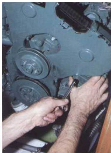
3 Desserrez l'axe de pivotement, la vis ou le boulon du tendeur.
