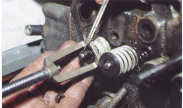
2 Comprimez le ressort, puis dégagez les clavettes tout en veillant à ce que le ressort ne saute pas. Attention à ne pas perdre les clavettes !
