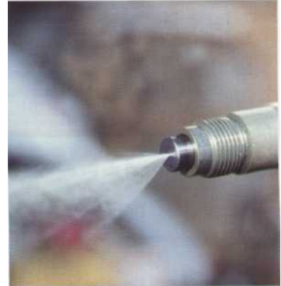
7 Vérifiez la qualité du jet en provoquant rapidement l'injection. Le jet doit être régulier, uniforme, symétrique. Dans le cas d'un injecteur à trous, vérifiez bien que tous les trous débitent.
