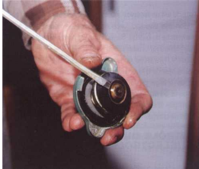
4 Vérifiez aussi le bon fonctionnement du clapet de dérivation en le soulevant délicatement avec un tournevis. Le clapet de dérivation empêche qu'un vide ne se crée dans le système de refroidissement lorsque le moteur est arrêté et commence à se refroidir.
