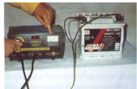
4 Ne dépassez pas l'intensité de charge. Exemple: batterie de 45 Ah = maximum admissible 9 A.
