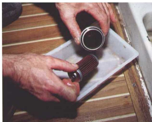
4 Retirez l'élément filtrant. Prévoyez pour ce faire, un petit récipient afin de récupérer le gazole et le filtre.
