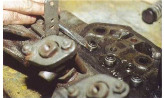
8 Déposez le joint de tige de soupape en faisant levier avec un tournevis.
