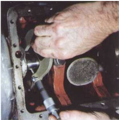
7 La mesure en deux points diamétralement opposés permet de vérifier l'ovalisation du maneton.
