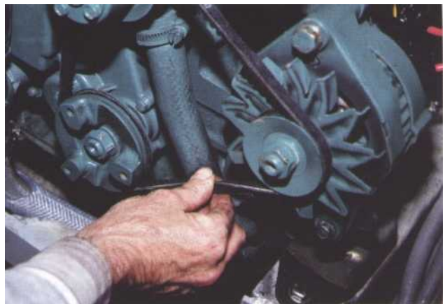
9 Vérifiez la tension après quelques heures de services
