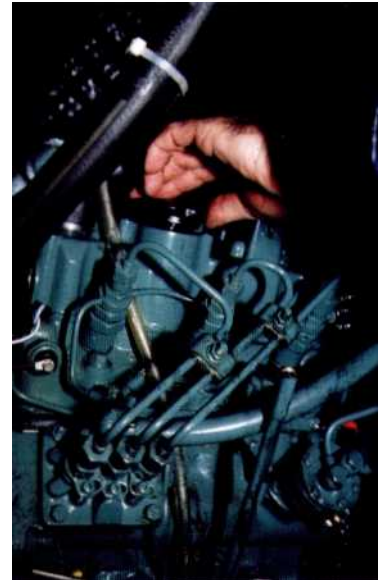
2 N'oubliez pas d'enlever le bouchon de remplissage afin de créer une prise d'air
