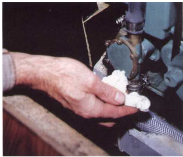
11 Ouvrez la vanne d'eau de mer et contrôlez le bon fonctionnement du circuit de refroidissement. Vérifiez qu'aucun suintement n'apparaisse au niveau de la plaque.
