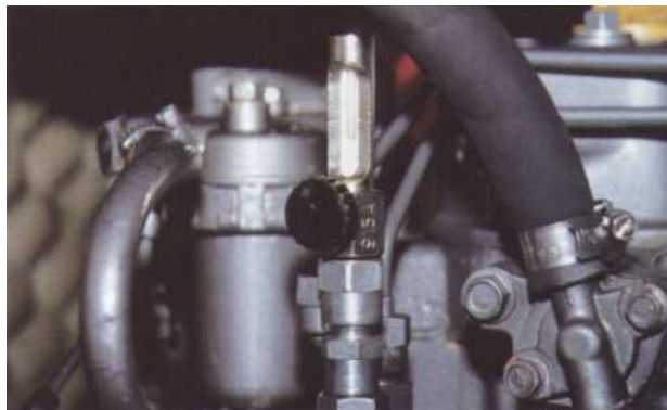
8 Le début d'injection sur un cylindre se signale par la montée d'une quantité de gazole sur la sortie haute pression de la pompe d'injection.
