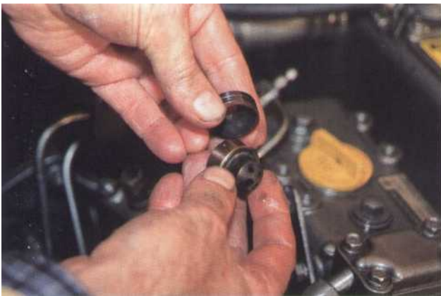
5 Pour déposer les chambres de précombustion (Yanmar), donnez un coup de démarreur. L'air chassé par le piston repoussera les chambres de combustion.
