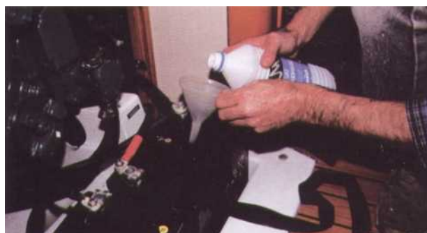
2 Si le niveau de l'électrolyte est insuffisant, ajoutez exclusivement de l'eau distillée ou déminéralisée. Utilisez à cet effet un petit entonnoir afin d'éviter de mettre de l'eau un peu partout au moment du remplissage.
