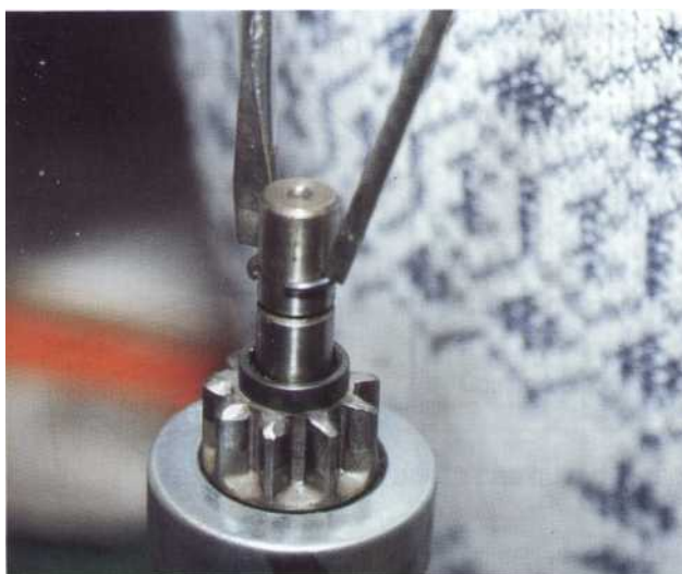
19 Lors du réassemblage du lanceur sur l'induit, lubrifiez légèrement les cannelures. Enfilez la butée du lanceur puis faites glisser le circlip sur l'extrémité de l'arbre de l'induit jusqu'à sa gorge.
