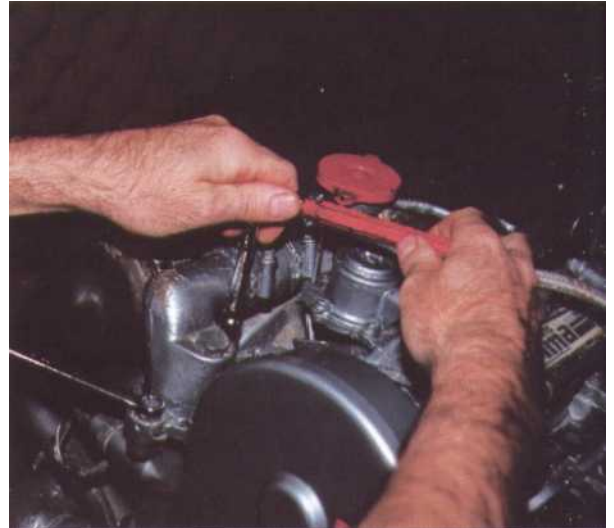
1 Pour accéder au thermostat, desserrez le collier de serrage de la durit puis dévissez les vis de fixation de la cloche de thermostat situé sur la culasse.
