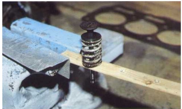
4 Installez la soupape et l'ensemble cuvette, ressort, rondelle sur un support pour repérer leur emplacement d'origine afin de les remonter au même endroit. Ici, les soupapes sont installées sur une lame en bois, percée de huit trous dont on a pris soin de repérer le coté du cylindre N° 1 (coté volant moteur) par une flèche.
