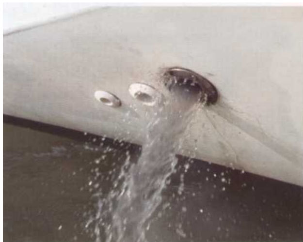
Vérifiez le bon fonctionnement de la pompe à eau à l'arrière du bateau.
