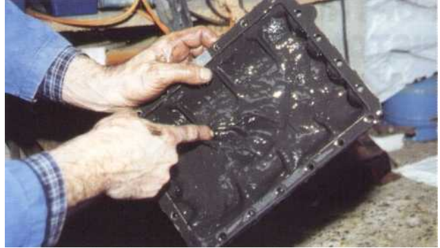
2 Remarquez tout ce dépôt au fond du carter.
