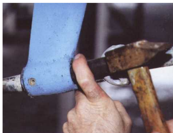
3 Etape plus délicate, extraire la bague. Un demi-tube d'un diamètre intérieur égal au diamètre de votre arbre permet de repousser facilement la bague. Un tournevis peut tout aussi bien faire l'affaire.
