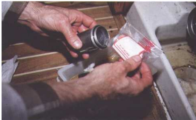
6 Remontez un filtre neuf. N'utilisez que des pièces d'origines car elles déterminent le bon fonctionnement du moteur et la garantie du constructeur.
