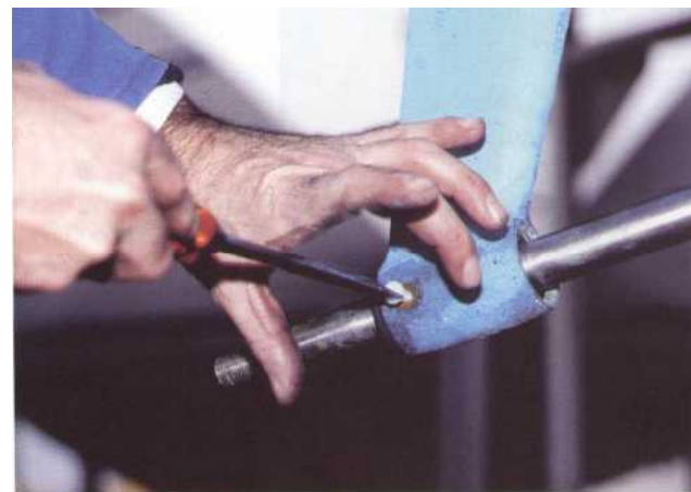
9 revissez les vis de blocage. Remplacez l'anode et reposez l'hélice
