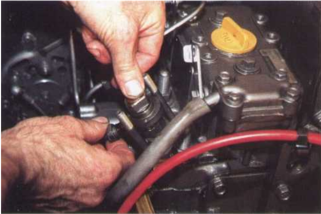
3 Dévisser puis déposez la bride de l'injecteur.
