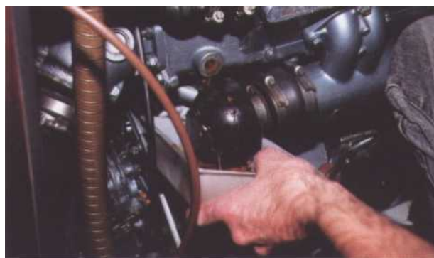
3 Vidangez. Notez le faible débit dû à l'obturation partielle de l'orifice de vidange par des dépôts et la couleur rouille du liquide.
