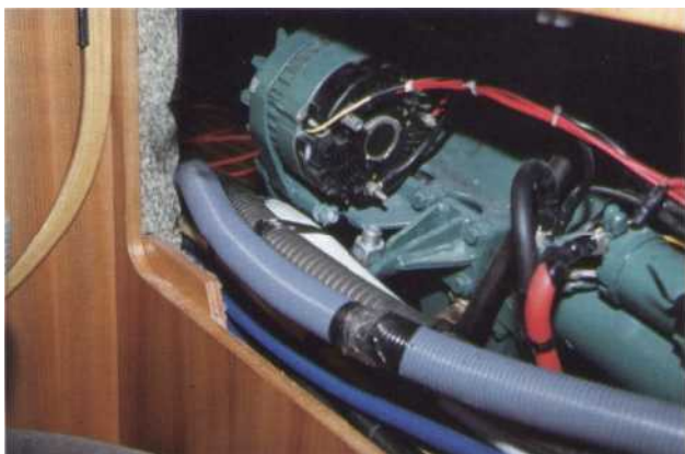
1 Repérez l'emplacement de l'alternateur et son accessibilité. Représentez sur une feuille l'implantation des bornes, la couleurs des fils et leur position respective.
