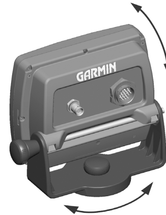
Réglez l'orientation pour obtenir l'angle de vue optimal
