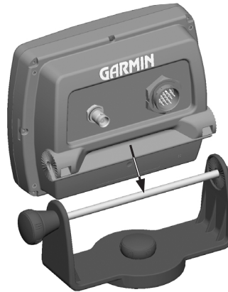
Insérez l'appareil dans l'étrier
