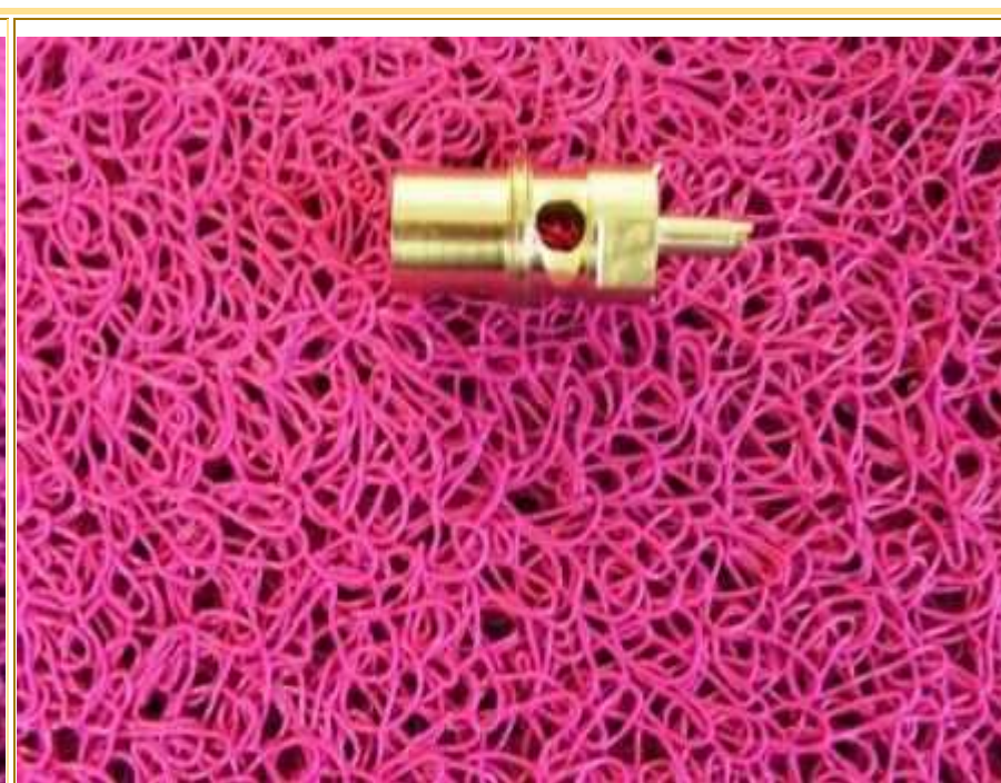
Limer l'orifice afin que la soudure adhère
