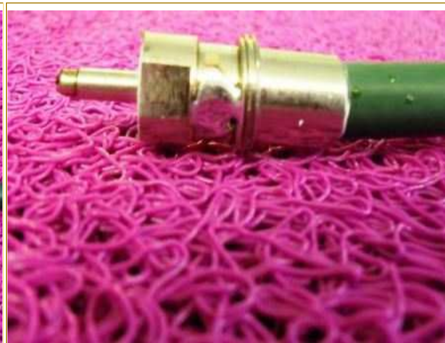
Souder le corps de la fiche à la tresse intérieure
