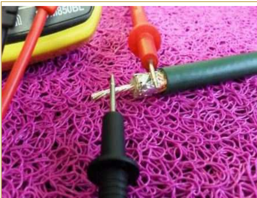
Vérifier l'isolation entre l'âme et la tresse
