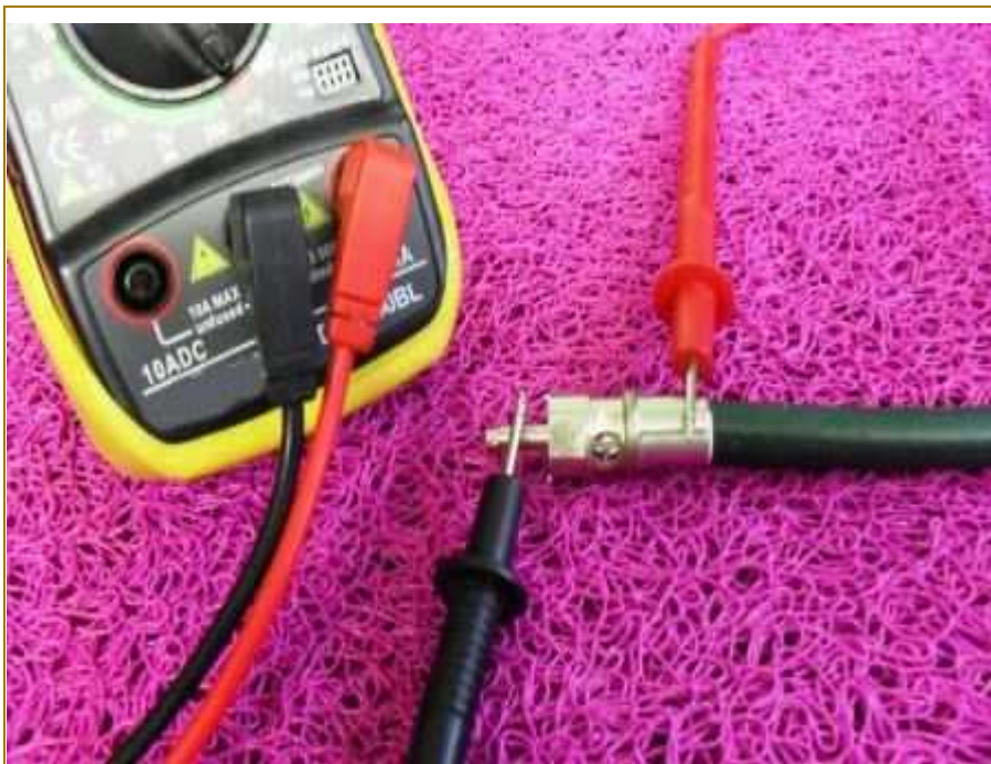
Vérifier l'isolation entre l'âme et la tresse
