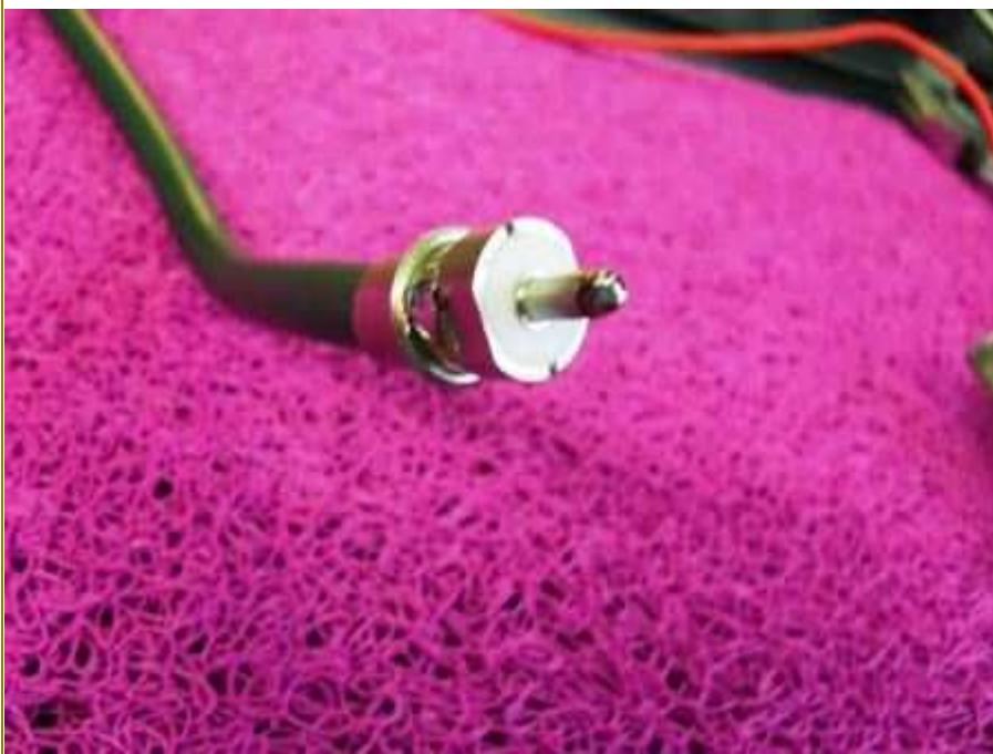
Souder l'âme centrale sans déborder limer l'exédent
