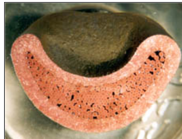
Vue en coupe d'un sertissage à un mandrin
