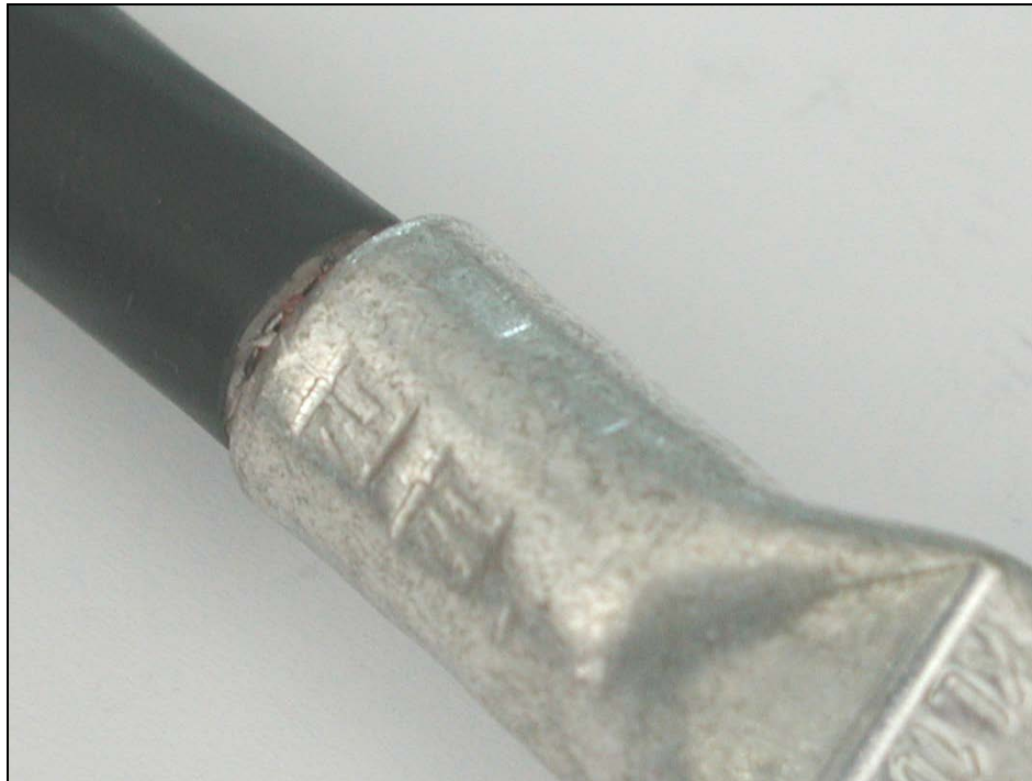
Sertissage insuffisant du raccord
