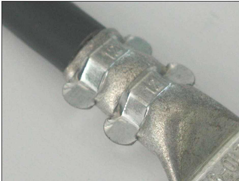
Sertissage excessif du raccord
