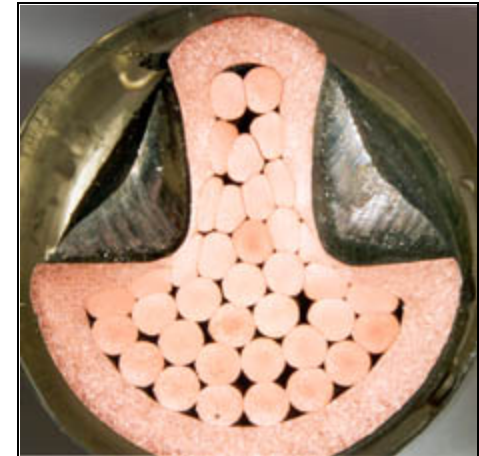
Vue en coupe d'un sertissage à encoche
