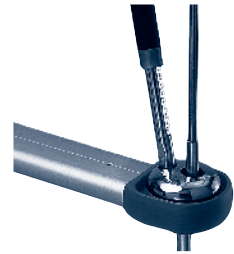
Embout de barre de flèche pour "Rod Tip Cup".
