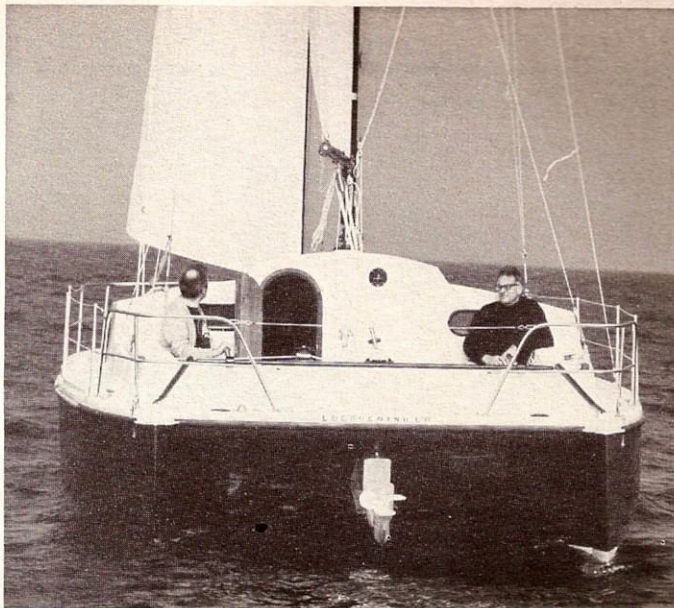
La transmission Z-drive du Quest 31 se relève à l'aide d'un simple palan.
