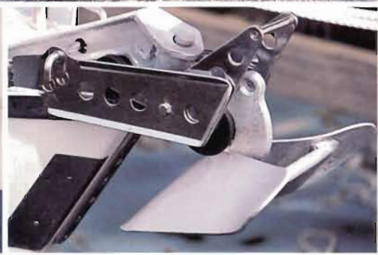
Bugbeschlag V4A mit Ankerwippe - Serie. S/S bow fittings with anchor seesaw - standard
