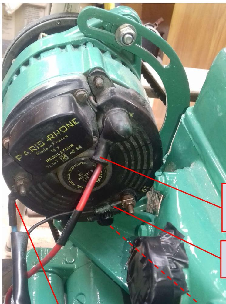
Repère +, Cable (6 mm<sup>2</sup>) vers tableau des coupes circuits, raccordé au séparateur de charge pour recharger les batteries
