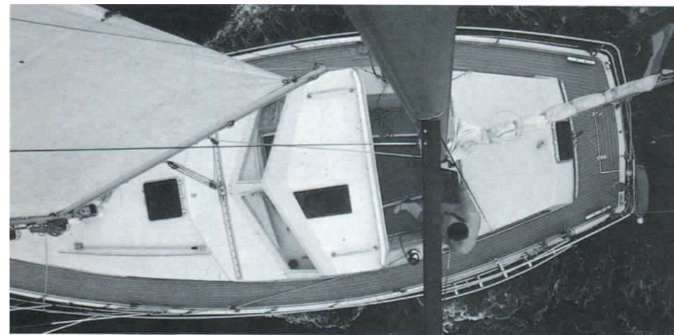
Le panneau teinté dans le toit rigide du poste de barre permet au barreur de contrôler le réglage des voiles.
