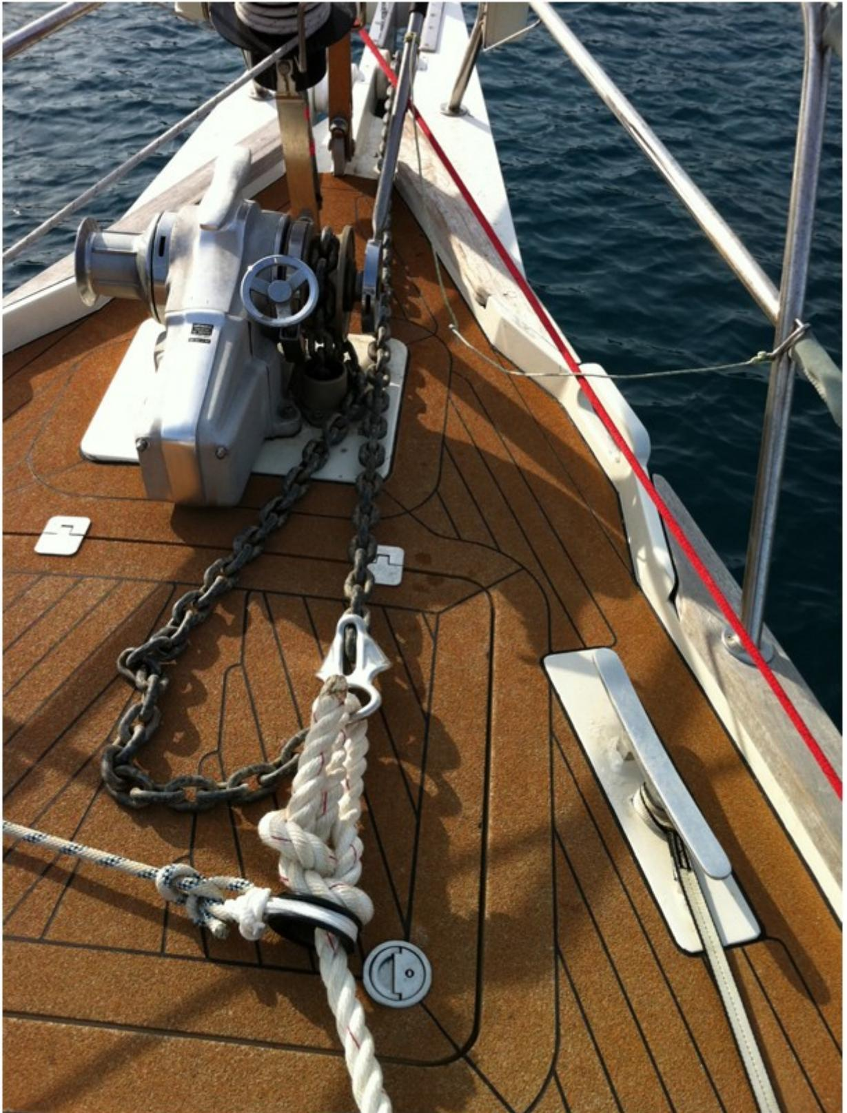
5- Soulever le bout amortisseur en vérifiant son bon positionnement et le tourner au taquet arrière.
