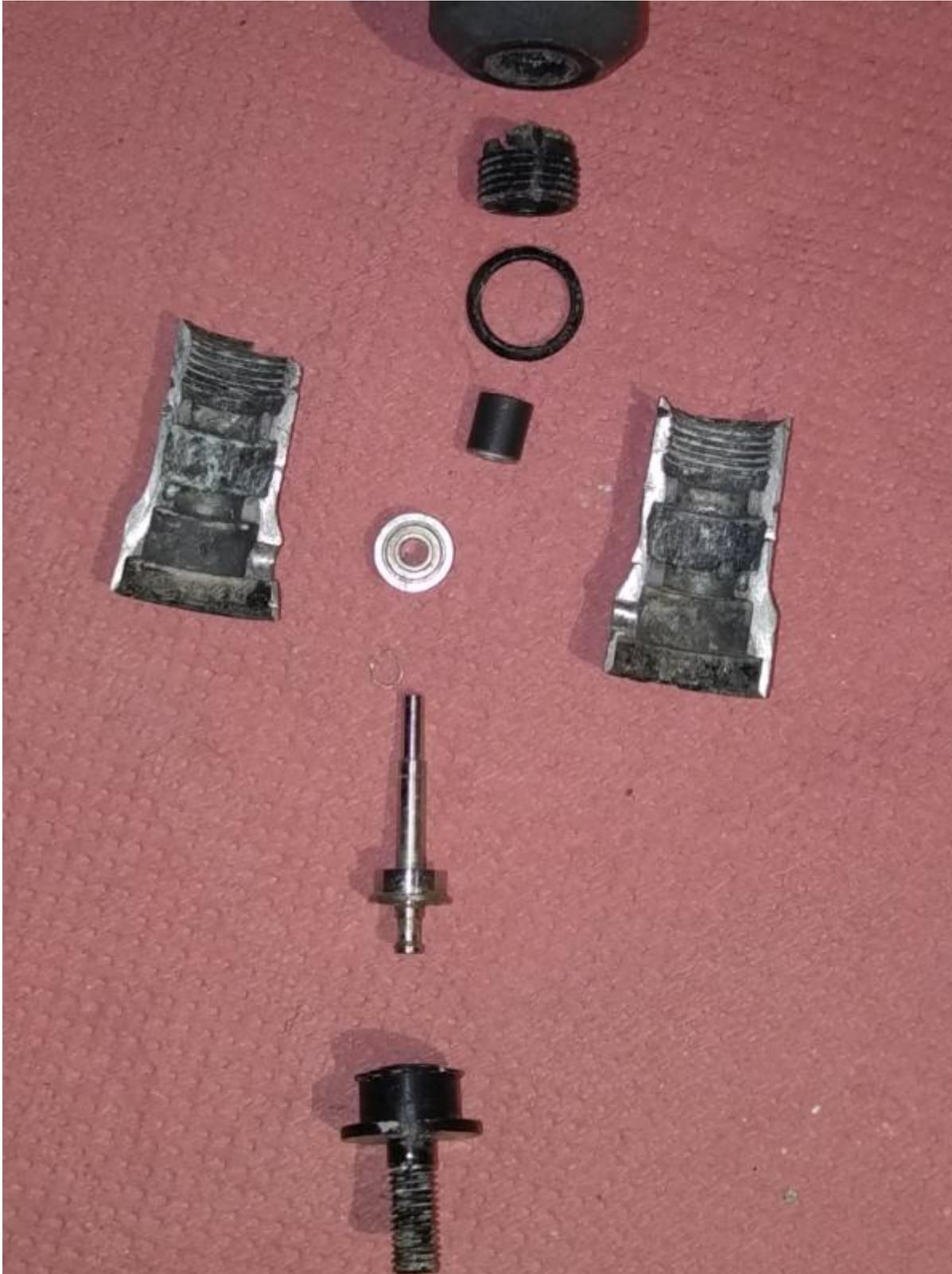
Moralité : chaque année démonter l'aérien, nettoyer le pas de vis et le graisser, remplacer le joint torique, lubrifier les axes et roulements puis remonter le tout, ça vous évitera de claquer pas mal de centaine d'euros...
