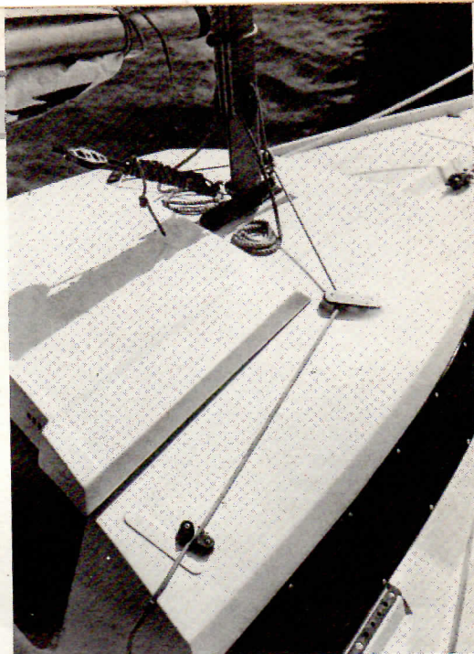
Des réas à plat roof permettent le retour des drisses au cockpit. En version standard, les drisses extérieures sont simplement tournées aux deux taquets du mât.
