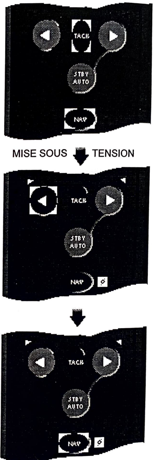
Fig 4.1 - Réglage du nombre de tours de barre
