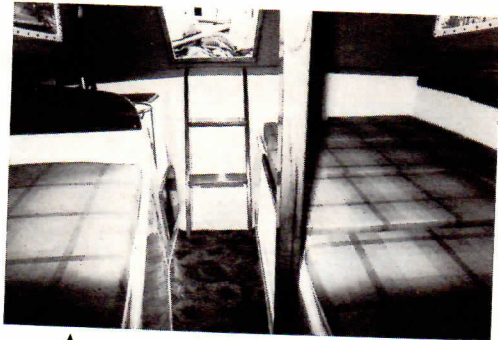
Le bloc d'emménagements moulé forme une cloison étanche entre la cabine et le cockpit.
