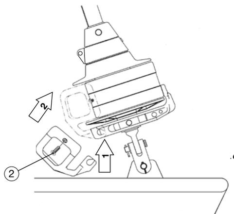
Engager le guide bosse dans le carter et le faire pivoter vers le haut en position de blocage. Serrer les vis ② (dans le carénage inox).
