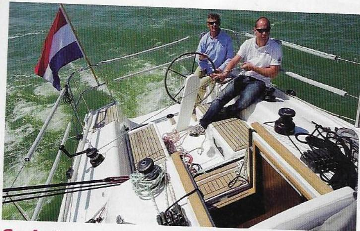
**Cockpit : tout est en place.** Rien à redire, tout y est, et l'accastillage est de qualité. En option, une barre à roue basculante à trois positions contrôlée par une pédale au pied. Pas de pataras, les barres de flèche angulées à 20 degrés assurant la tenue du mât alu.
