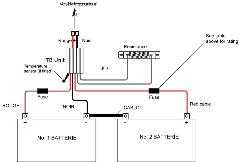
SCHEMA DE CABLAGE AVEC 4TB ET PANNEAU SOLAIRE
